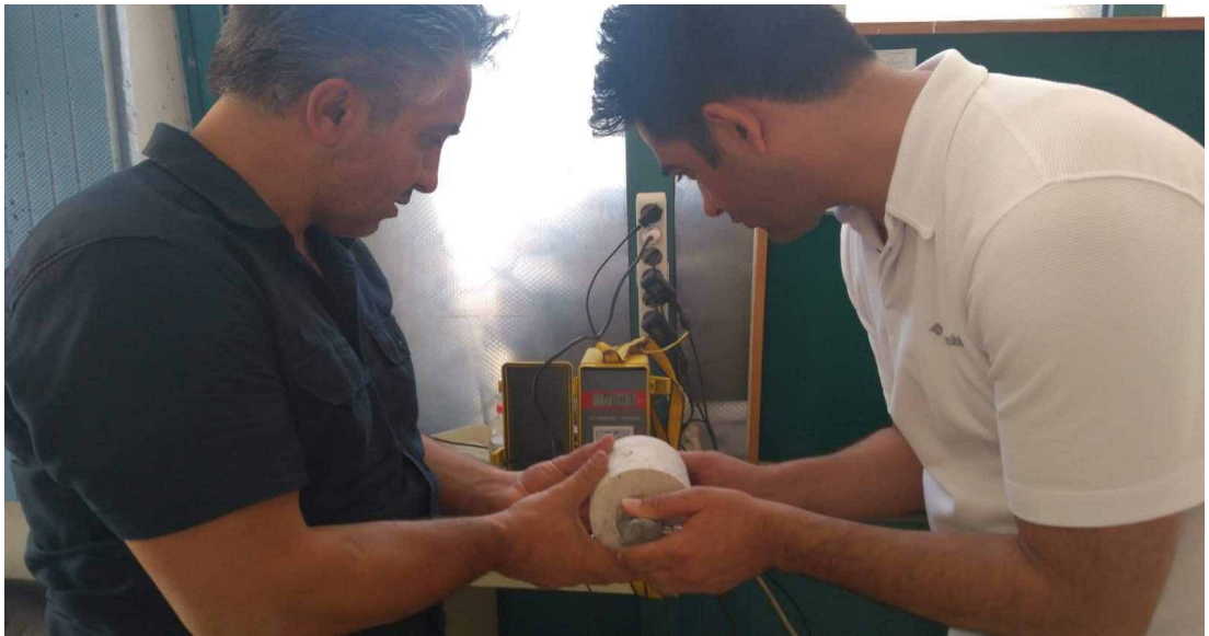
Şekil 6.14. Ultrasonik dalga hızının ölçülmesi
