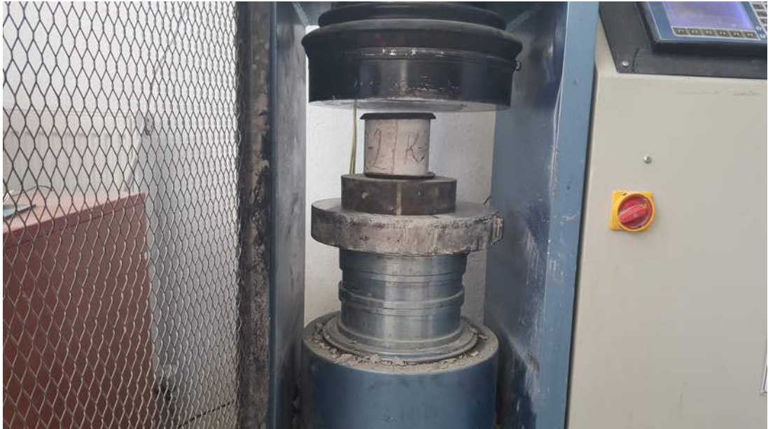
Şekil 6.16. Numunenin Yerleştirilmesi ve UCS Deneyinin gerçekleştirilmesi
