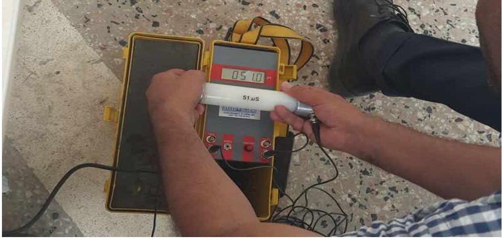
Şekil 6.12. Ultrasonik test cihazı kalibrasyonunun yapılması
