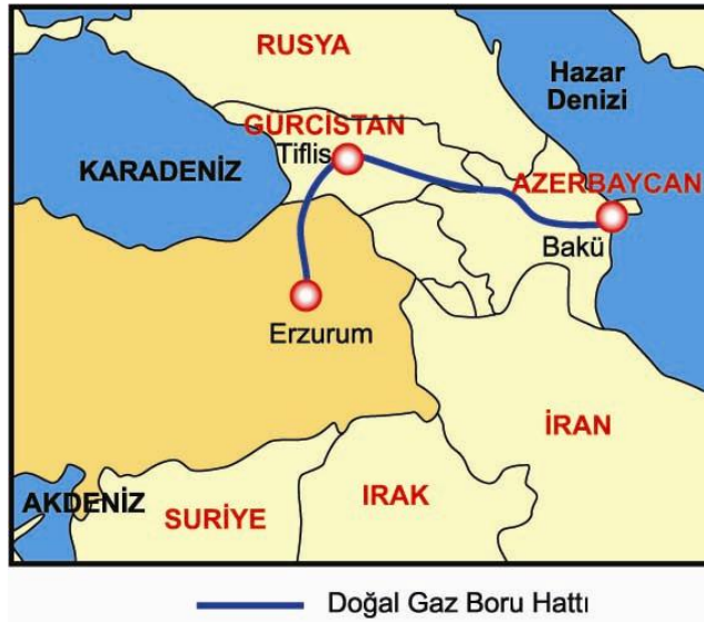
Şekil 17: BTE Doğal Gaz Boru Hattı 65
