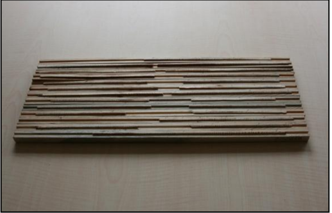
Foto 5: Ahşap Taşıyıcılarda Artım Kalemleri
