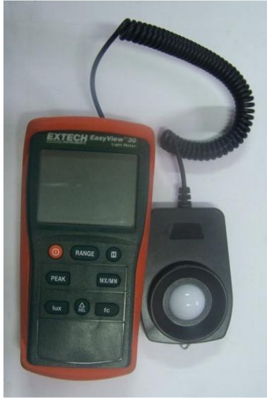
Resim 36: Işık ölçümü yapılan lüks metre (EXTECH Easy view 3).
