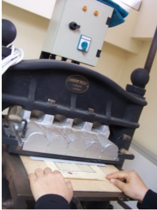
Resim 65: Formaların ıstampa makinesinde preslerek dikişe hazır hale getirilmesi.
