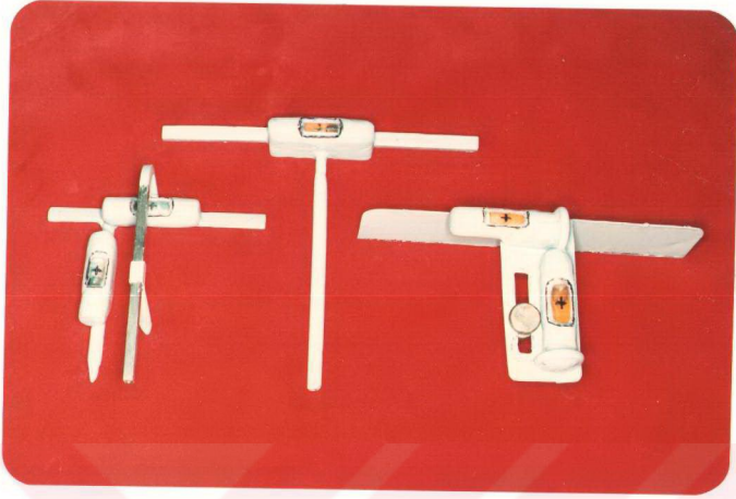
Resim 4- Modellerin yatay ve dikey yönde çizim aygıtlarında standart oryantasyonlarının sağlanması için yararlandığımız düzeçler (düzeçler, su terazisi -kabarçıklı düzeç- prensiplerine göre hazırlanmışlardır).
