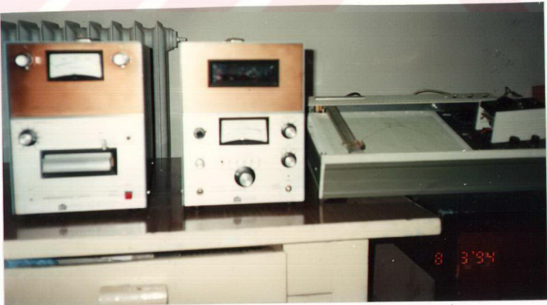
RESİM 1- TLD okuyucu ünitesi
