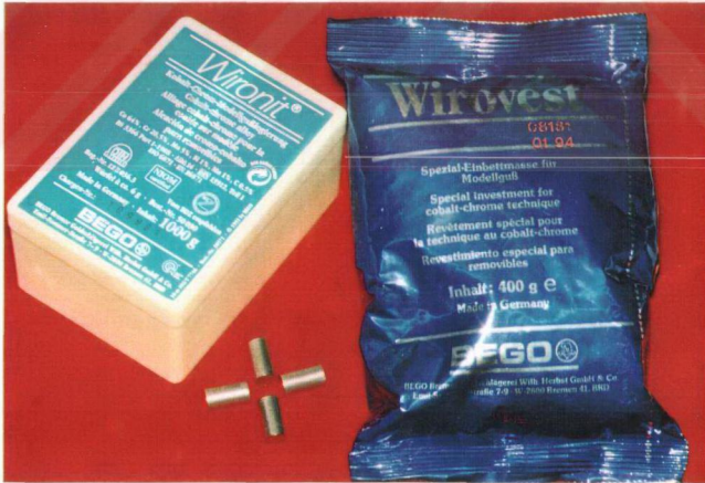
Resim 2 : Çalışmamızda Cr-Co alaşımlarından elde edilen metal kaide plaklarının yapımı için kullanılan revetman (Wirovest, Bego, Germany) ve kullanılan Cr-Co metal alaşımı (Wironit)
