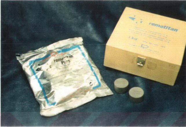
Resim 7 : Saf titanyumdan elde edilen metal kaide plaklarının yapımında kullanılan revetman (Rematitan Plus) ve metal (Rematitan)
