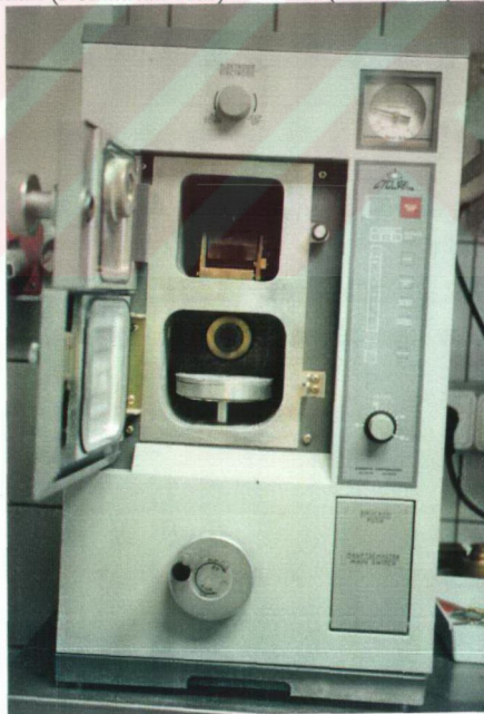
Resim 8 : Titanyum dökümlerin elde edilmesinde kullandığımız argon gazı koruması altında ark eritmeli vakum-basınçlı döküm makinesi
