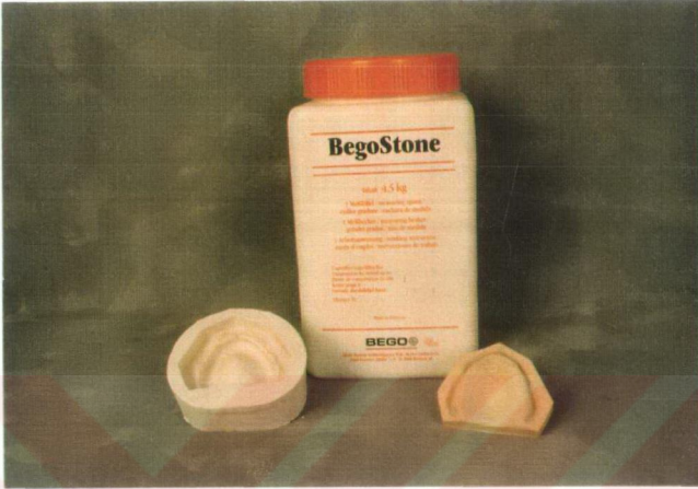
Resim 1 : Silikon matris, kullanılan Tip IV sert alçı ve bu alçıdan elde edilen model
