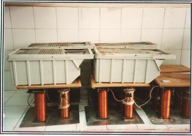
Resim 1: Manyetik alan uygulanmasında kullanılan bobin düzeneđi.
