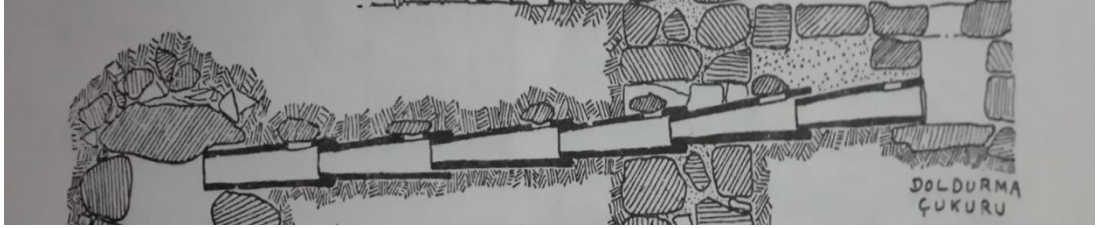
Çizim 1. Huni formu kil borular (Naumann, 1998: 209)
