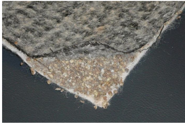
Fotoğraf 188. Jeosentetik kil astar (claysandminerals.com/materials/bentonites)
