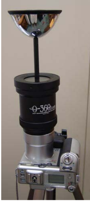
Resim 76 : Bellissimo Inc 0-360 firmasının Panoramic Optic isimli lensinin kameraya bağlanması 26
