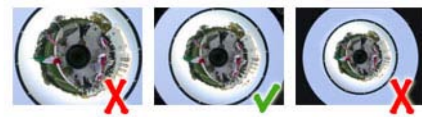
Resim 67 : Kameranın panoramik aynaya doğru biçimde odaklanması 12
