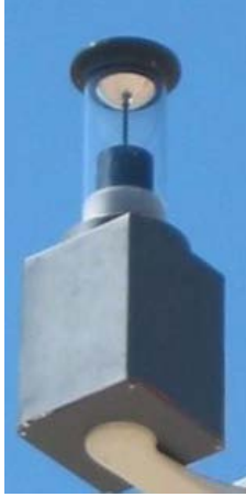
Resim 72 : Remote Reality firmasının Omni Alert isimli panoramik lense sahip kamerası 15
