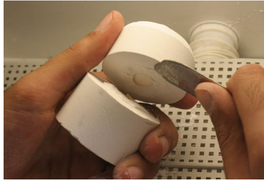
Şekil 112: Alçı bıçağı ile kalıbın açılması
