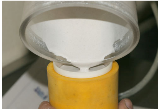
Şekil 100: Manşet kalıbına revetman doldurulması
