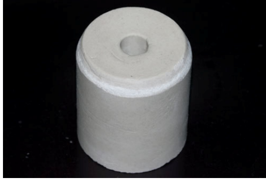
Şekil 101: Hazırlığı tamamlanmış revetman kalıp
