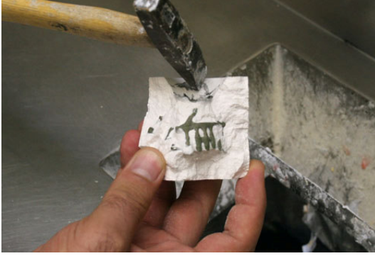
Şekil 37: Revetman kalıbın açılması
