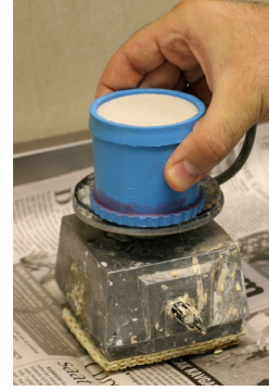
Şekil 23: Vibratör üzerinde hava kabarcıklarının eliminasyonu
