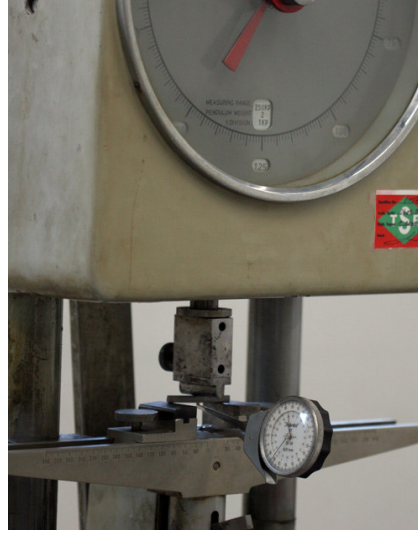
Şekil 139: Elastiklik katsayısı ölçümü
