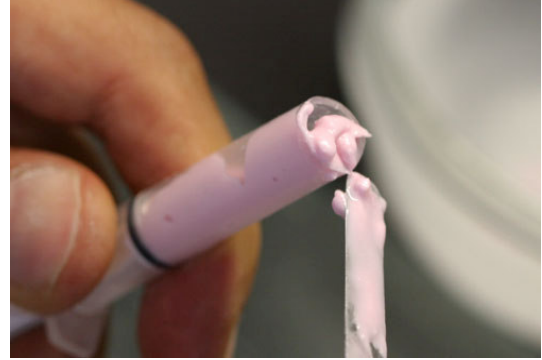
Şekil 75: Hamurun kalıba yerleştirilmesi
