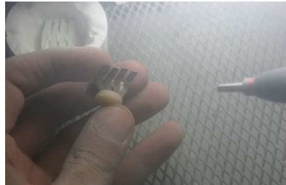
Şekil 114: 2 bar basınç ile kuşlama
