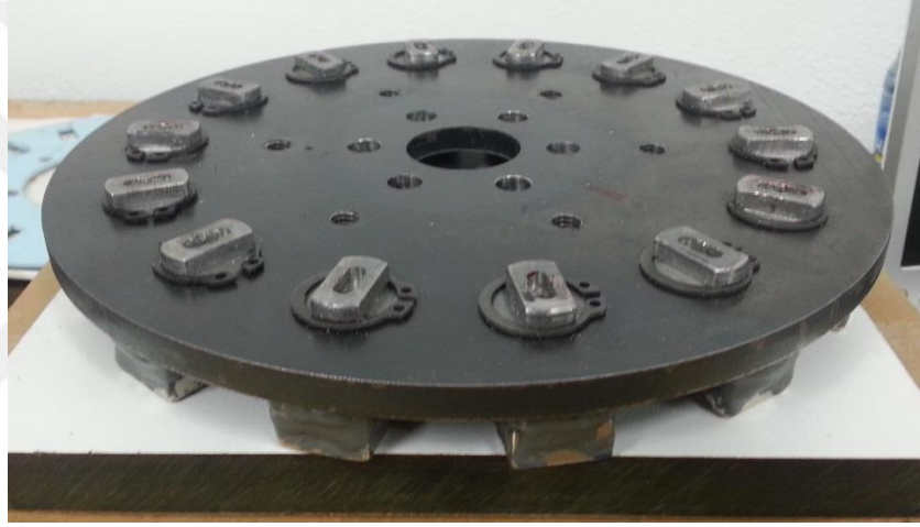
Şekil 5.7 : Eksen döndürme parçalarının yerleştirildiği rotor kalıbı.
