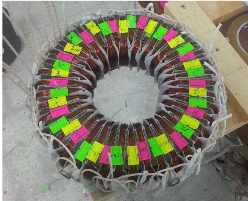
Şekil 5.3 : Sargısı ve bağlantıları tamamlanan stator.
