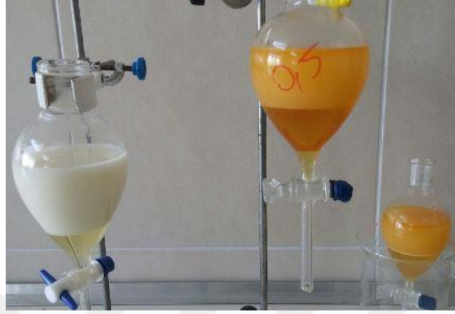
Şekil 3.6: Saf su ile yıkanan biyodizelin ayrımı.
