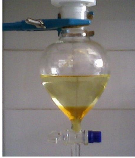
Şekil 3.4: Ayırma hunisiyle biyodizel-gliserin ayrımı.
