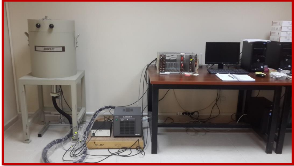
Şekil 3.6: Ortec GEM 70P4-95 model HPGe dedektorlü gama spektrometre sistemi.
