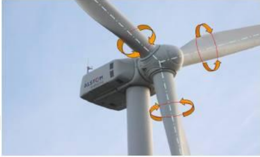
Şekil 3.19: Hatve mekanizması (Kanat açısı ayarlama)[71].
