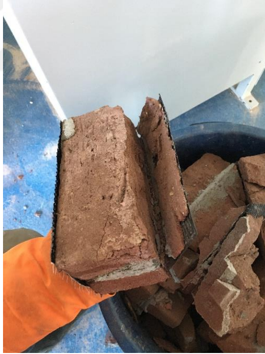
Resim 4.4. CFRPB04 numunesinin test sonrası durumu
