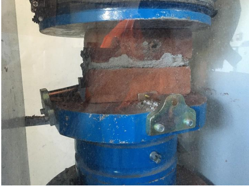
Resim 3.24. Murfor® ile güçlendirilmiş numunelerde basınç deneyinin gerçekleştirilmesi
