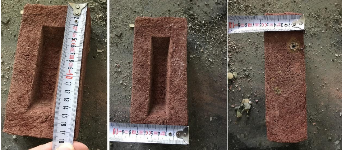
Resim 3.4. TS EN 771-1 standartlarına uymayan bir harman tuđlası.
