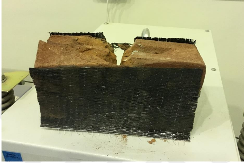
Resim 4.9. 3-noktalı eğilme deneyi sonrası, kuvvet yönüne dik yapıştırılmış olan CFRP kumaşın fiziki durumu
