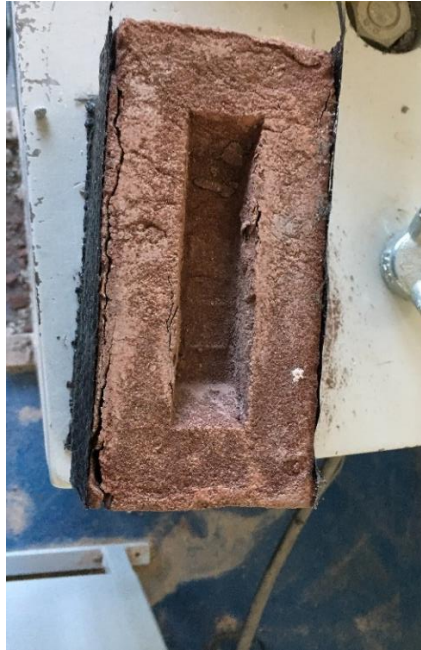
Resim 4.2. CFRPB02 numunesinin test sonrası durumu
