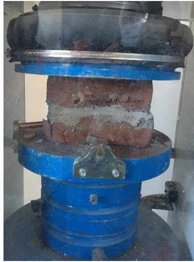
Resim 3.19. Şahit numunelerin basınç deneyi platformuna yerleştirilmesi
