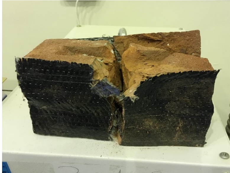
Resim 4.10. 3-noktalı eğilme deneyi sonrası, kuvvet yönüne paralel yapıştırılmış olan CFRP kumaşın fiziki durumu
