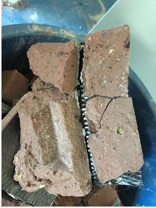
Resim 4.3. CFRPB03 numunesinin test sonrası durumu
