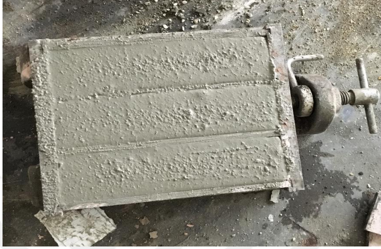
Resim 3.6. Harç malzemesinin 40x40x160 mm kalıba dökülmesi
