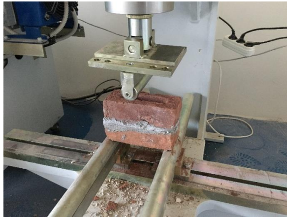
Resim 3.20. Şahit numunelerde 3-noktalı eğilme deneyinin gerçekleştirilmesi
