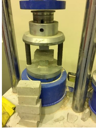
Resim 3.18. Numunelerde basınç deneyinin gerçekleştirilmesi
