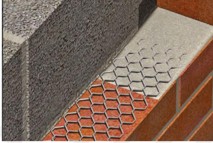
Şekil 2.6. Izgara tip yatay derz donatısı
