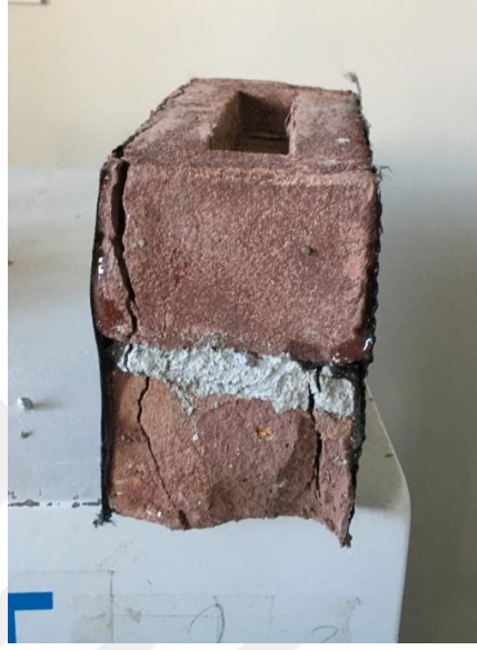
Resim 4.1. CFRPB01 numunesinin test sonrası durumu
