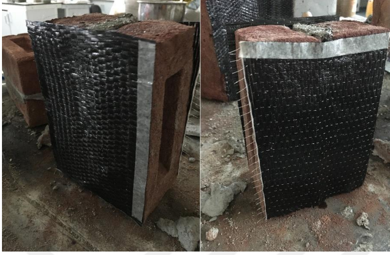
Resim 3.15. CFRP kumaşın yan yüzeylere epoksi reçineyle yapıştırılması
