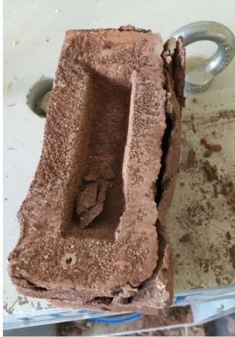
Resim 4.8. Basınç deneyi sonrası Murfor® yatay derz donatısı ile güçlendirilmiş numunede oluşan çatlak görünümü
