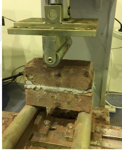
Resim 3.23. Murfor® yatay derz donatısı ile güçlendirilmiş numunelerde 3-noktalı eğilme deneyinin gerçekleştirilmesi
