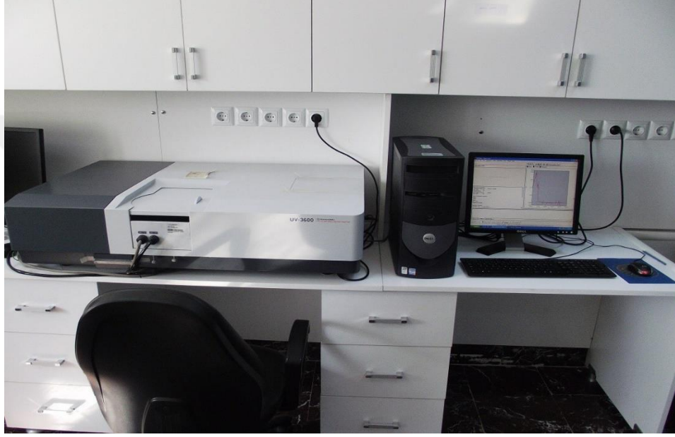
Şekil 3.2. TiO 2 ve ZnO:TiO 2 ince filmlerin U-V ölçümleri için kullanılan UV-VIS spektrofotometre cihazı [93]
