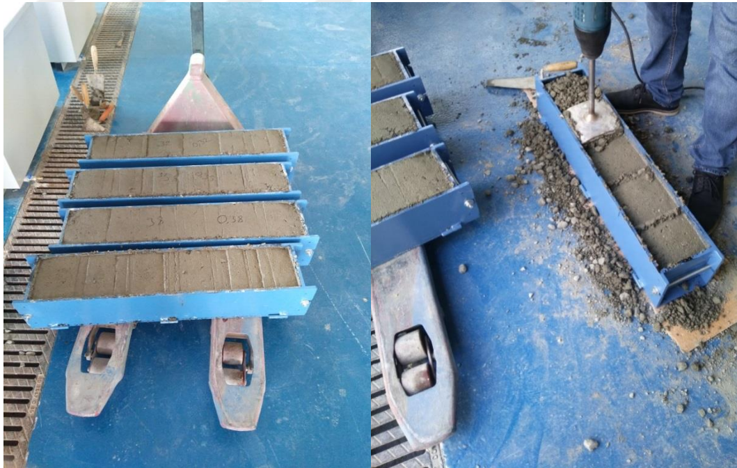
Şekil 5.18: Kiriş numune üretimi.
