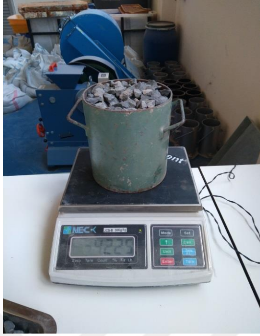
Şekil 5.7: Gevşek birim hacim ağırlık deneyi.
