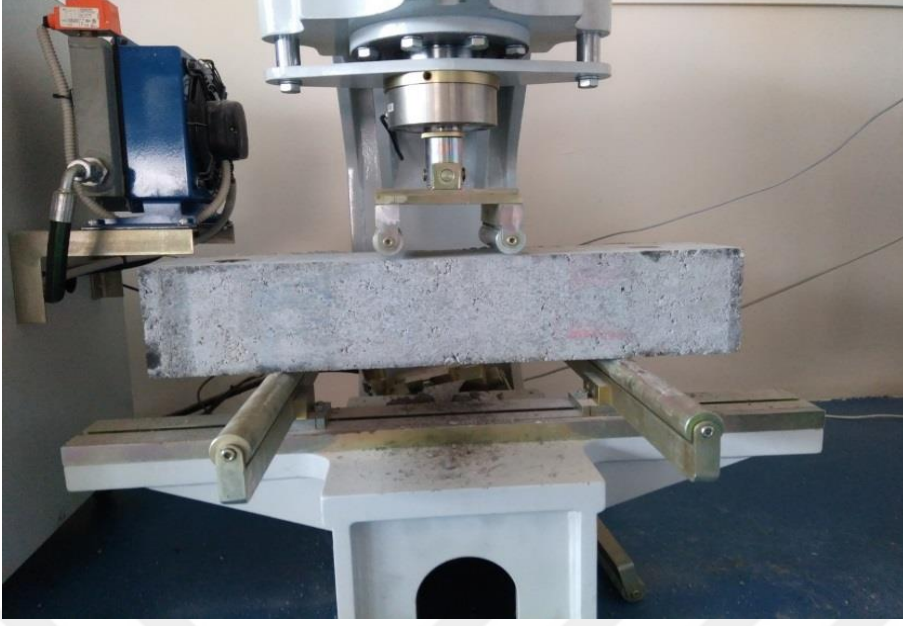
Şekil 5.19: Kiriş beton numune kırımının yapılması.
