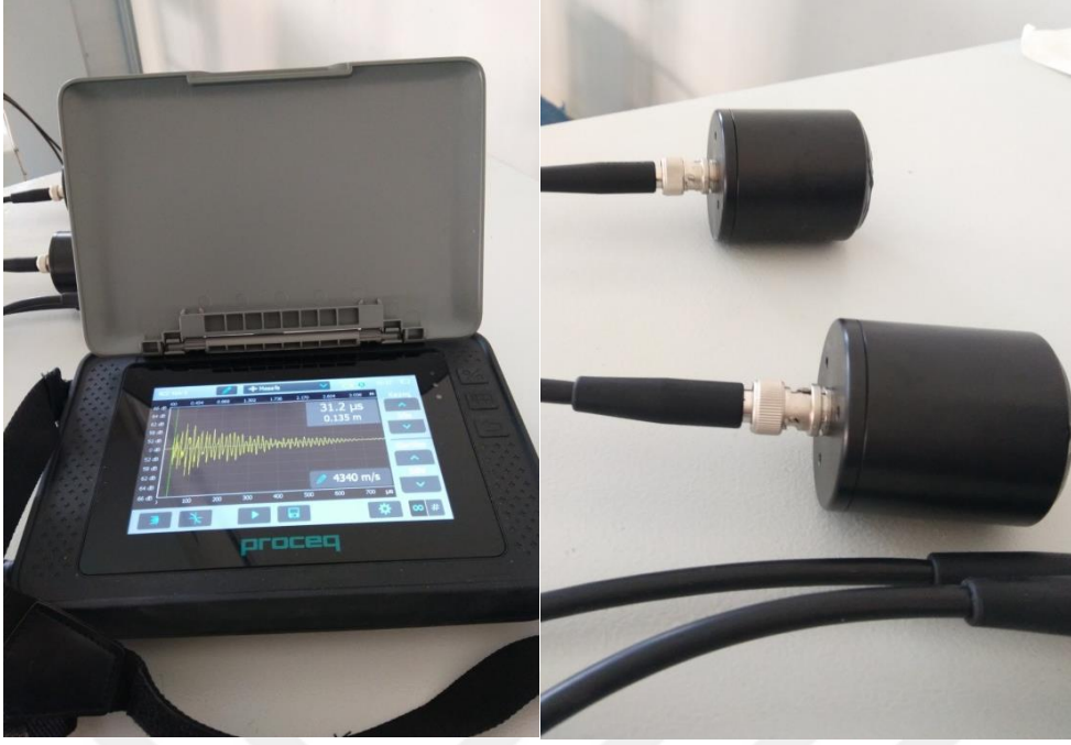
Şekil 5.21: Ultrasonik test cihazı.
