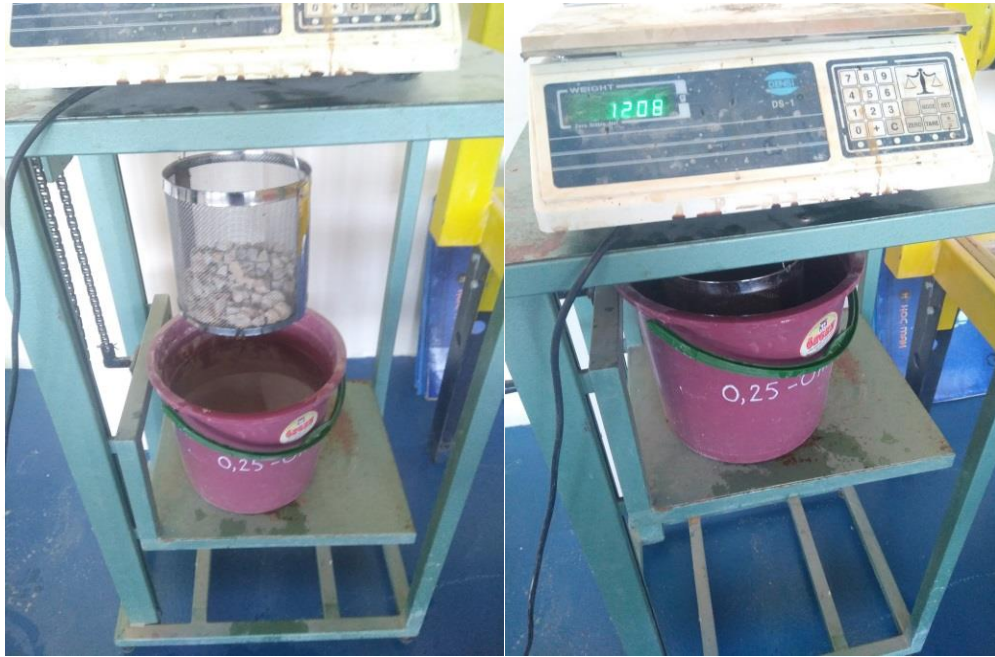
Şekil 5.9: İri agregada özgül ağırlık deneyi.
