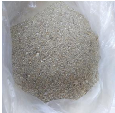
Şekil 5.6: Deneysel çalışmalarda kullanılan doğal kum.
