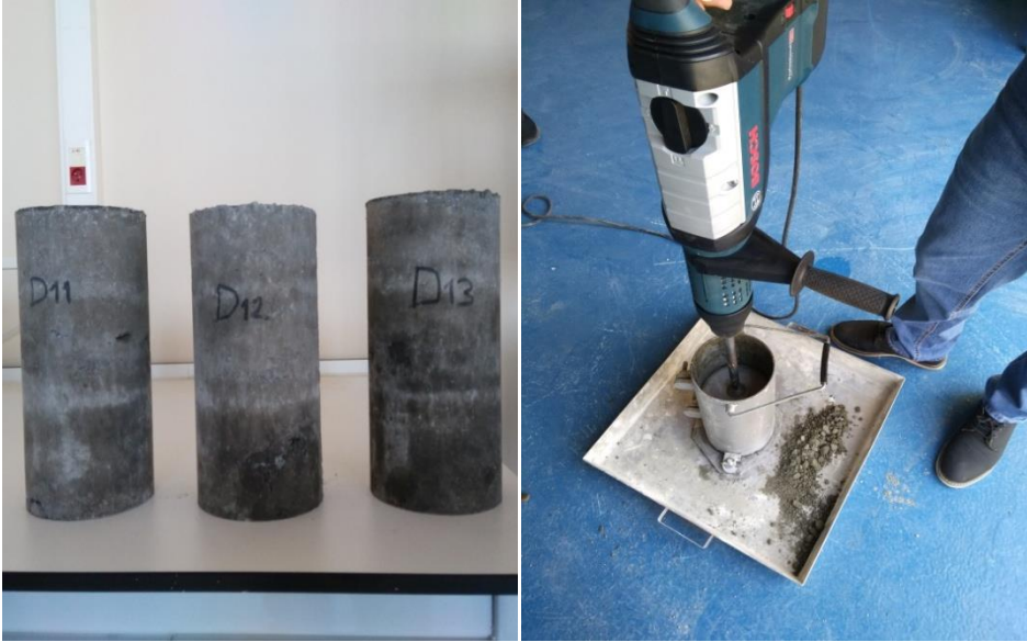
Şekil 5.17: Silindir beton numune üretimi.
