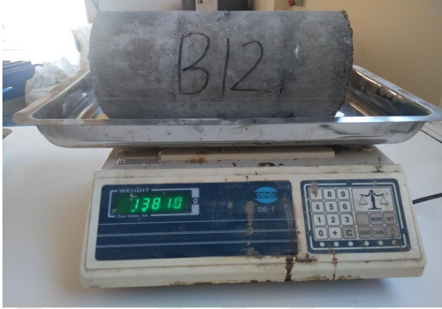
Şekil 5.15: Betonun birim hacim ağırlığının hesaplanması.
