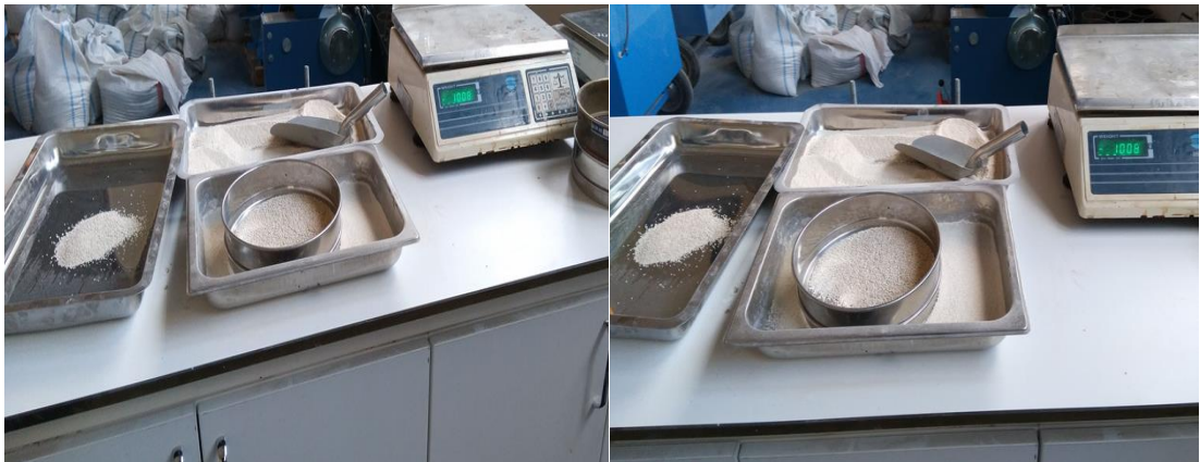
Şekil 5.14: Elek analizi deneyi.
