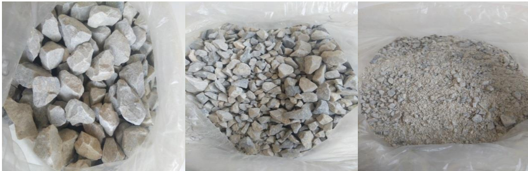
Şekil 5.1: Deneysel çalışmalarda kullanılan dolomit agregaları.
