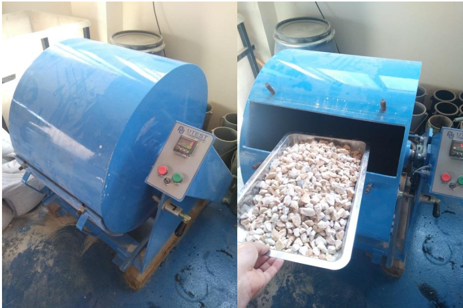
Şekil 5.13: Los Angeles deneyi.
