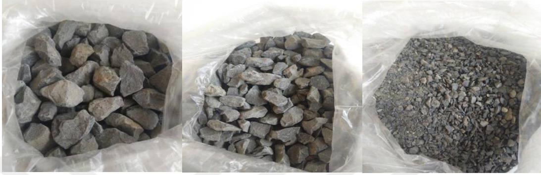
Şekil 5.2: Deneysel çalışmalarda kullanılan bazalt agregaları.
