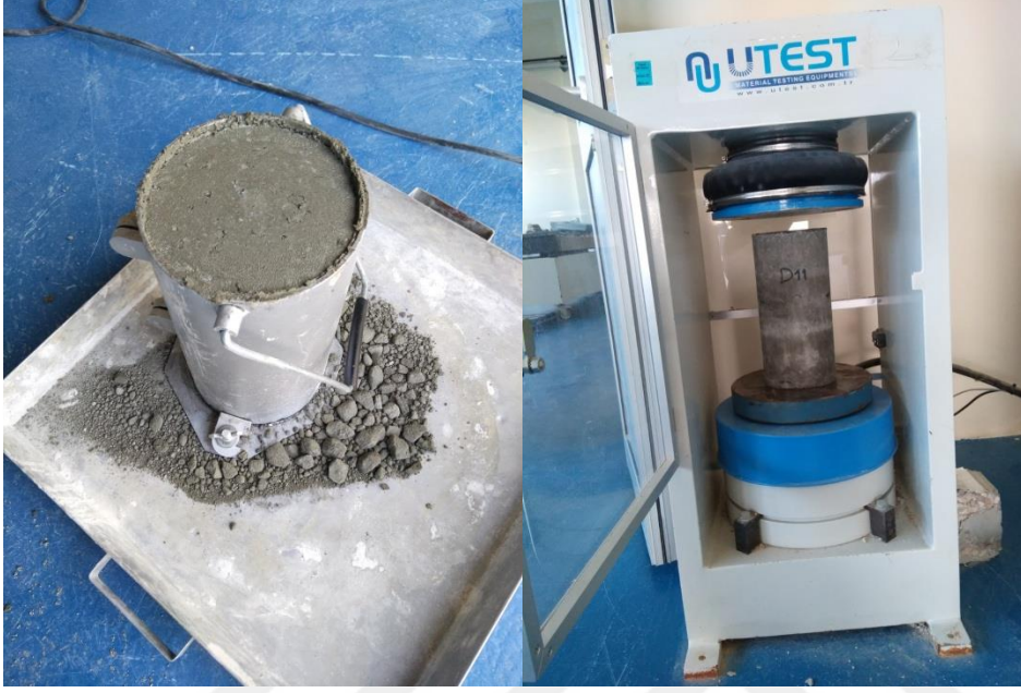
Şekil 5.16: Silindir beton numune üretimi ve kırımı.
