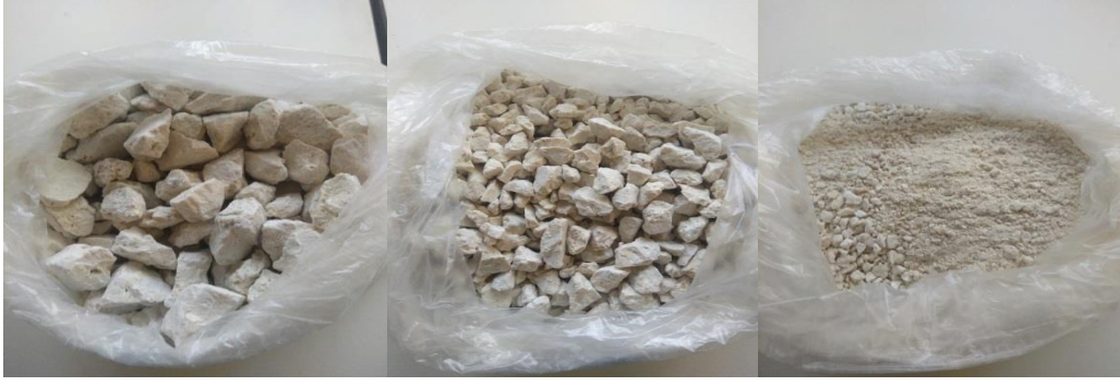
Şekil 5.4: Deneysel çalışmalarda kullanılan kalker I agregaları.
