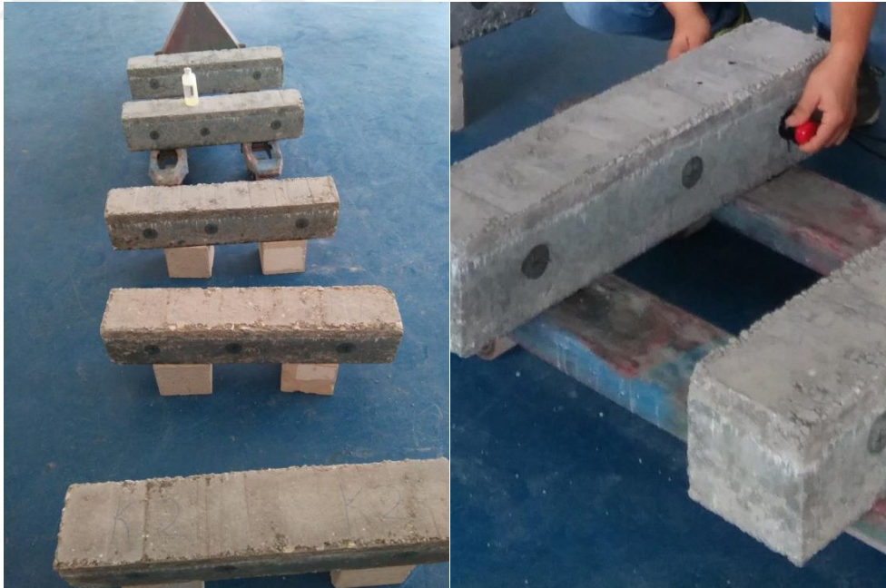
Şekil 5.20: Ultrases geiş hızı ve dinamik elastisite modülü tespit çalışmaları.
