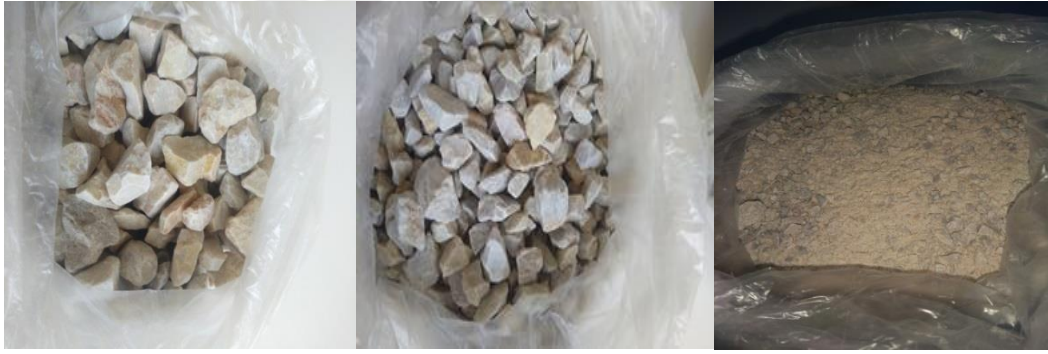
Şekil 5.5: Deneysel çalışmalarda kullanılan kalker II agregaları.
