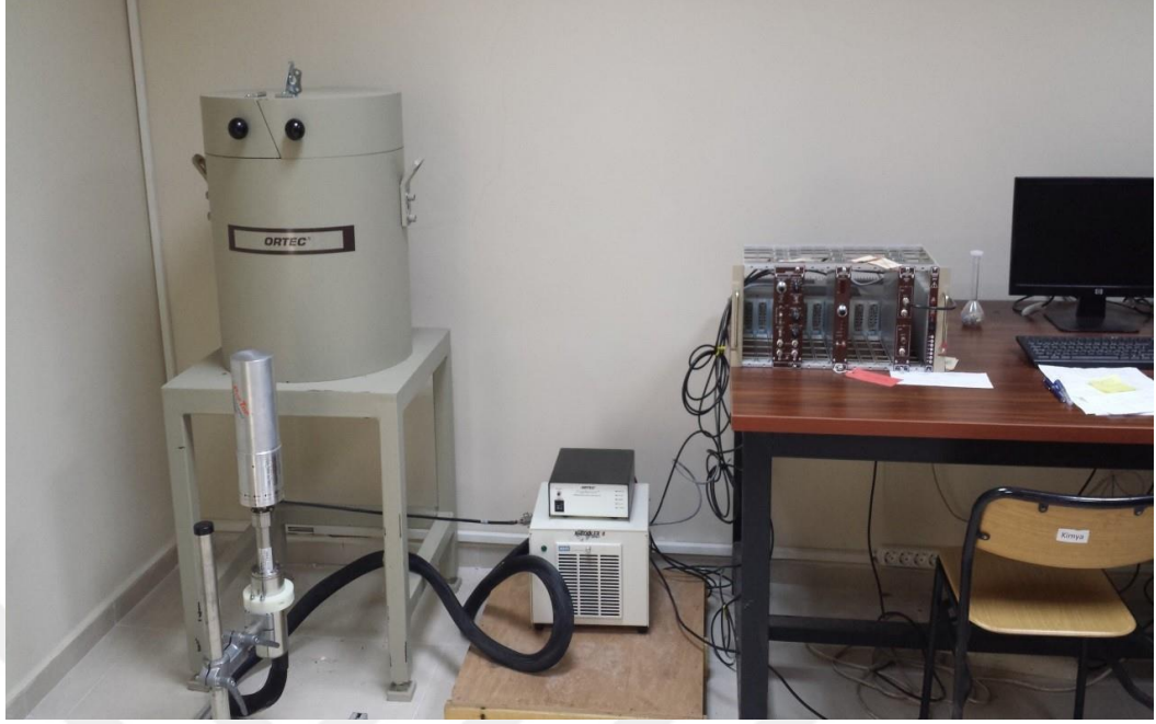
Şekil 3.8: Kırklareli Üniversitesi Merkezi Araştırma Laboratuvarında bulunan HPGe Gama Işını Dedektörü.
