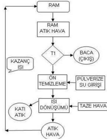
Şekil 2.26 : Isı kazanımı otomasyon akış diyagramı
