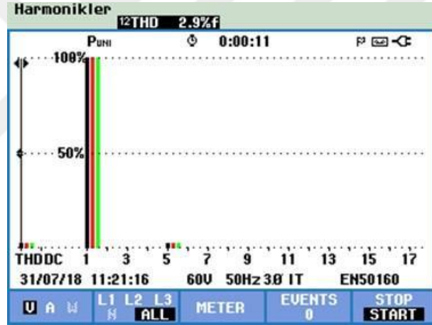
Şekil 6.81 : 3 Faz gerilim harmonik (Thdv) değerleri ( 38 0 yüksüz).
