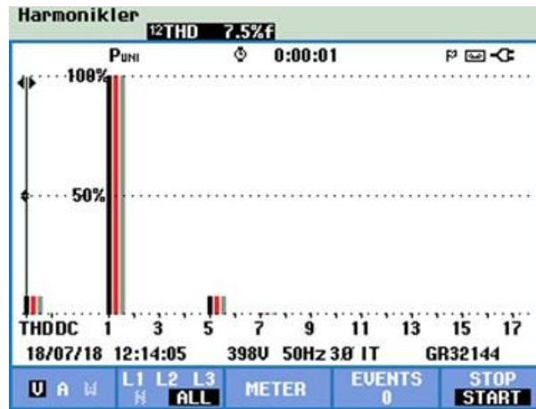
Şekil 6.29 : 3 Faz gerilim harmonik (Thdv) değerleri (30 0 yüksüz).
