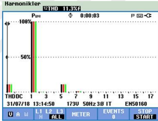
Şekil 6.3 : 3 Faz gerilim harmonik (Thdv) değerleri (0° yüksüz).
