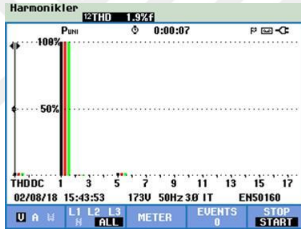
Şekil 6.185 : 3 Faz gerilim harmonik (Thdv) değerleri (36 0 yüksüz).
