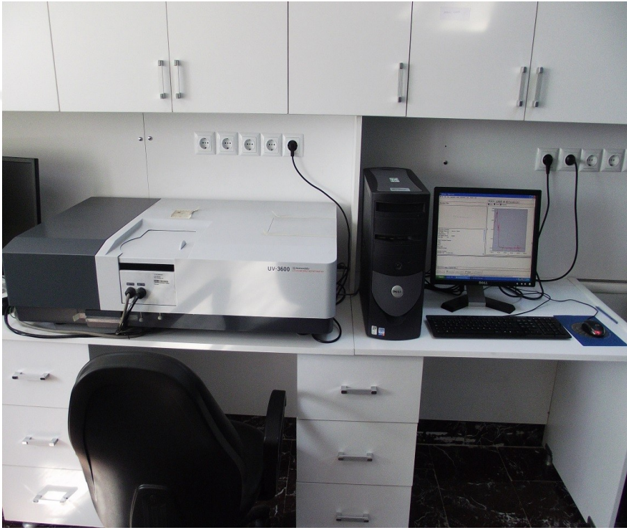
Şekil 3.2: Katkısız ZnO ve Ag Katkılı ZnO diyotlarının U-V ölçümleri için kullanılan UV-VIS spektrofotometre cihazı
