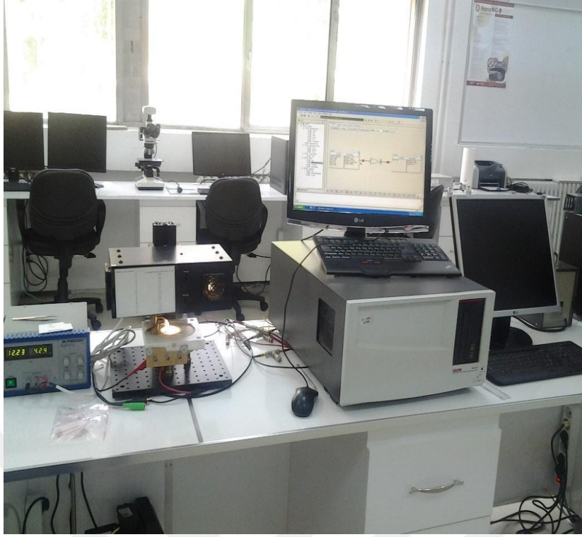
Şekil 3.4: Katkısız ZnO ve Ag Katkılı ZnO diyotlarının I-V, C-V ve I-t ölçümleri için kullanılan deney düzeneği
