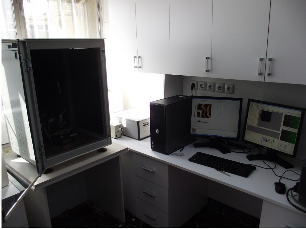
Şekil 3.3: Katkısız ZnO ve Ag Katkılı ZnO diyotlarının yüzey ölçümleri için kullanılan AFM cihazı
