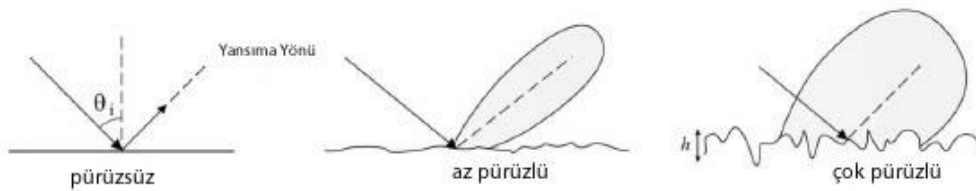
Şekil 2.3 : Yüzey pürüzlülüğünün yansımaya üzerindeki etkisi.
