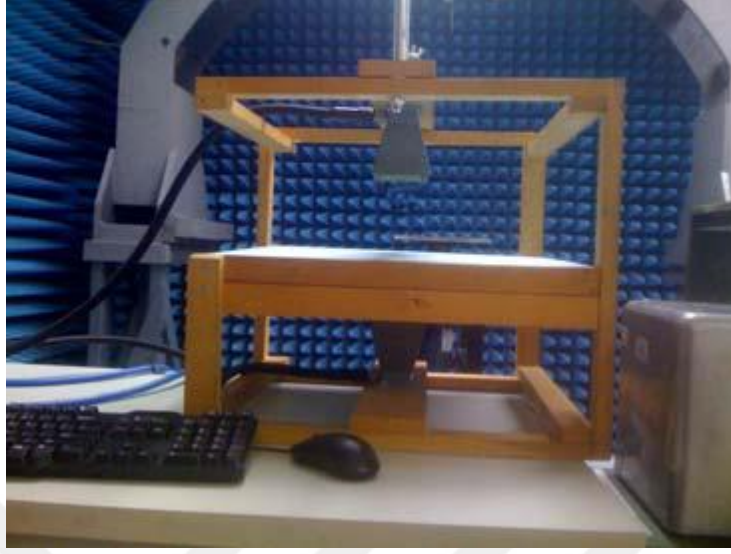
Şekil 5.3 : Fabrikasyonu yapılarak ölçümleri alınacak olan FSY için hazırlanan düzenek.
