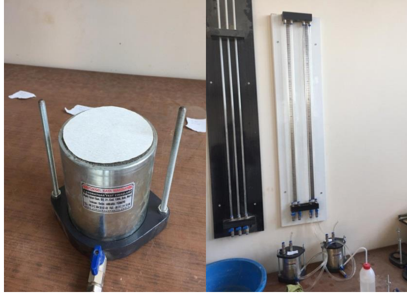
Şekil 4.5 : Düşen seviyeli permeabilite deney düzeneği
