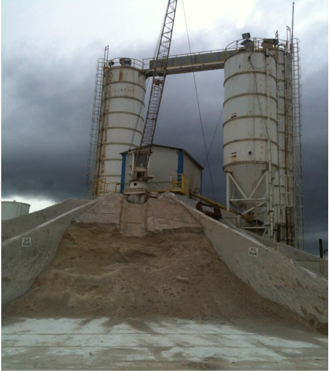
Şekil 3.4 : Yıldız tip skreyperli hazır beton santrali.
