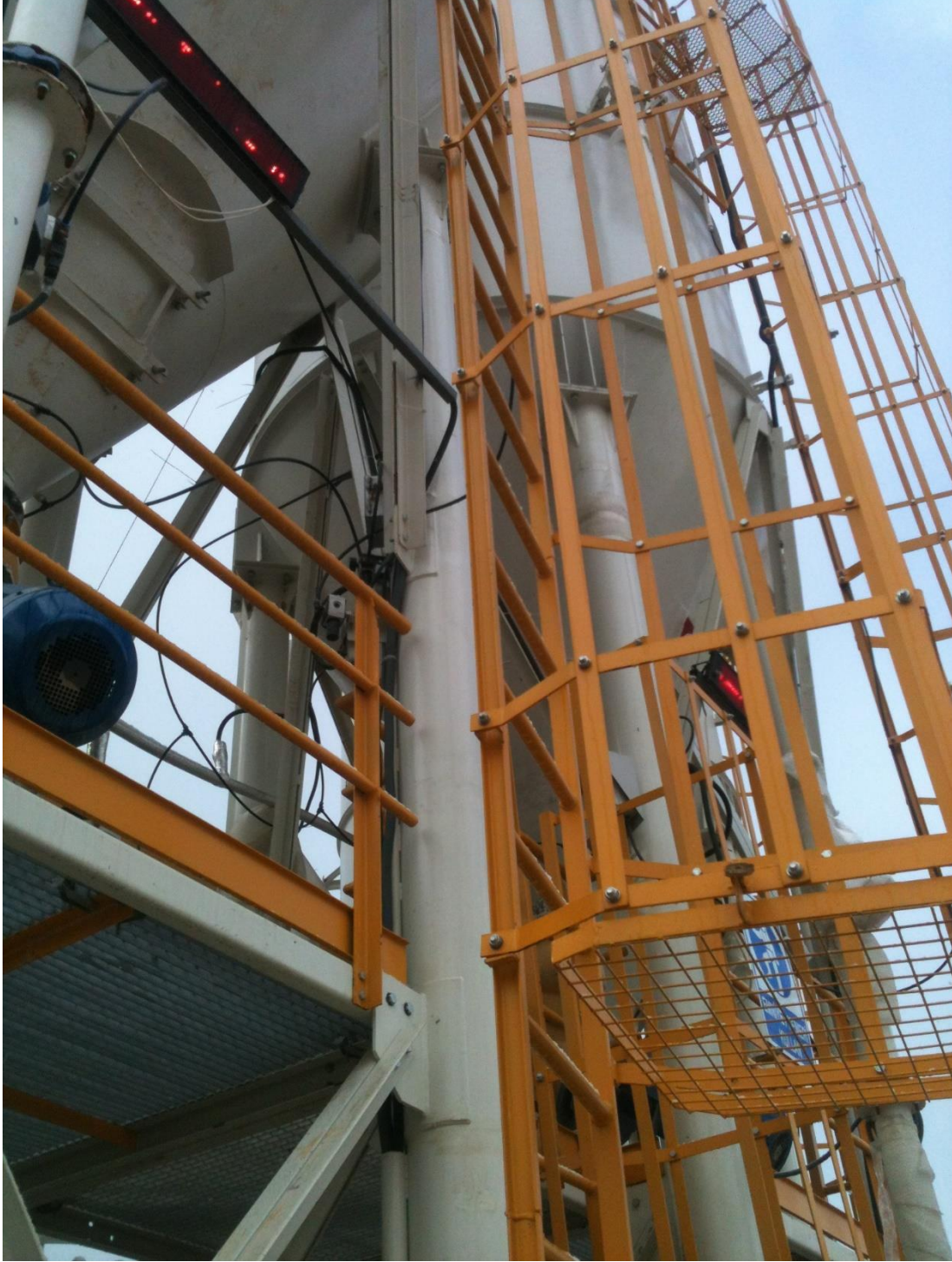
Őekil 5.14 : imento silolarına eriřim iin kullanılan gemici merdiven ađzı izinsiz giriřlere karřı kapatılması.
