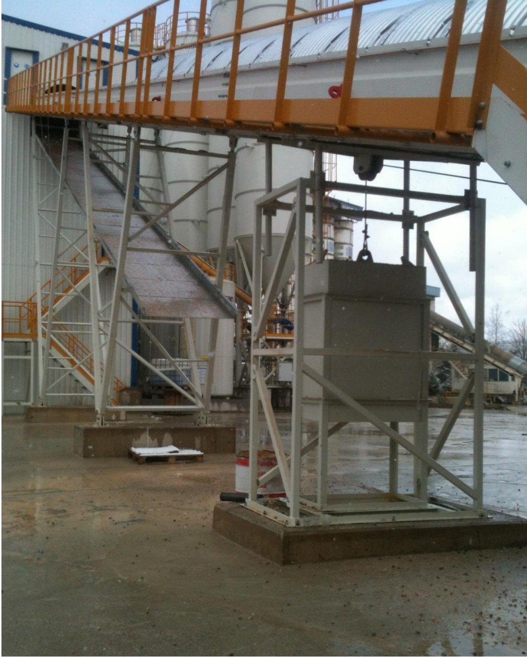
Şekil 5.9 : Bant sistemlerinin altında agrega toplama tavası.
