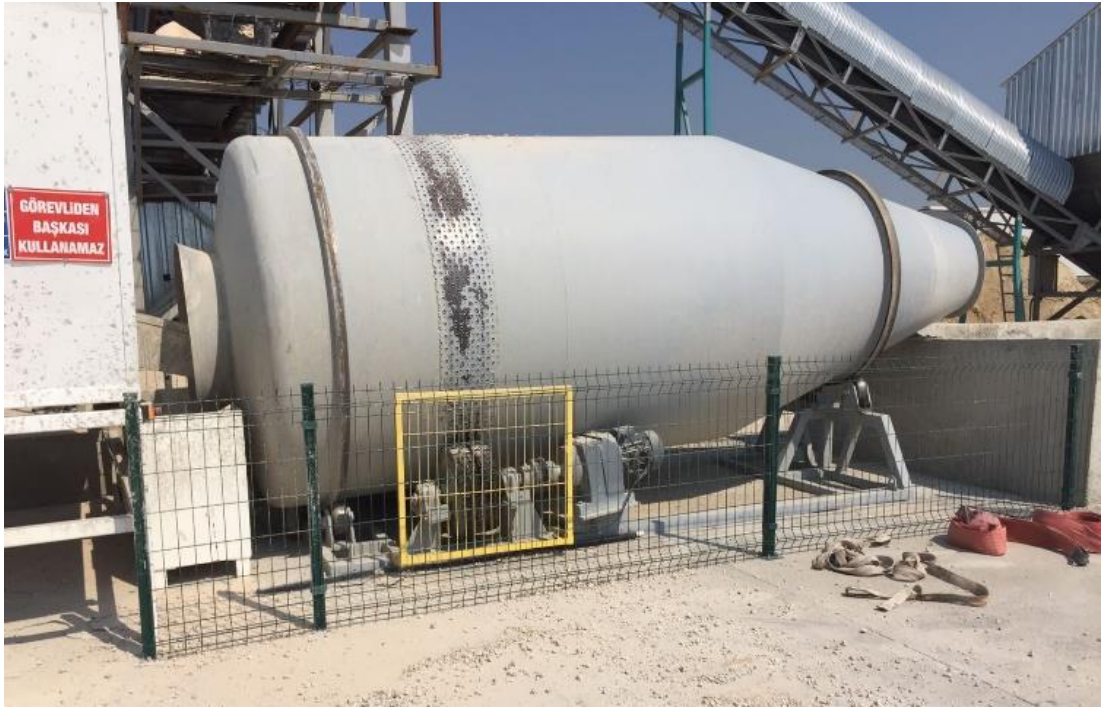
Şekil 5.13 : Hareketli ve döner kısımlarına erişim engellenmiş geri dönüşüm kazanı.
