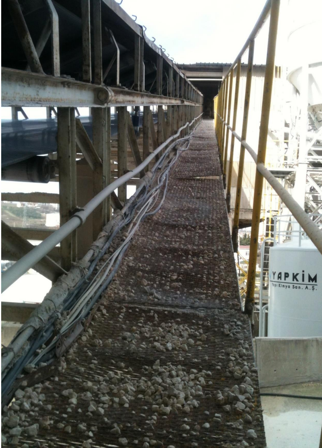
řekil 4.9 : Agrega tařıma bantı yanında bulunan platform zerinde biriken agregalar.
