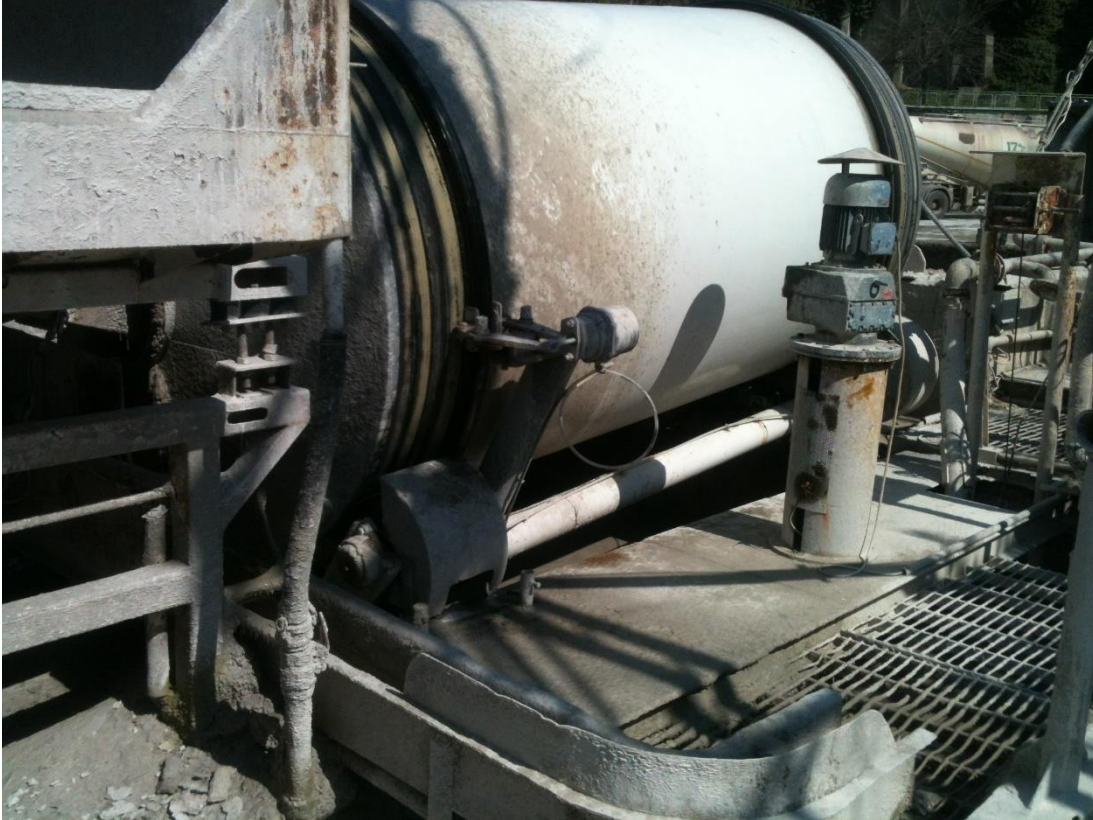
Şekil 4.15 : Döner ve hareketli bölgesi açıkta bulunan geri dönüşüm kazanı.
