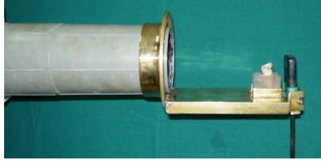
Şekil 3-2: Standart radyografiler alabilmek amacı ile yapılan özel metalik düzenek
