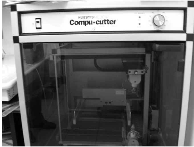
Şekil 3.6: Huestis Compu-cutter III Otomatik Blok Kesici
