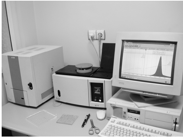
Şekil 3.7: Fimel LTM, TLD Okuyucusu ve Fırını
