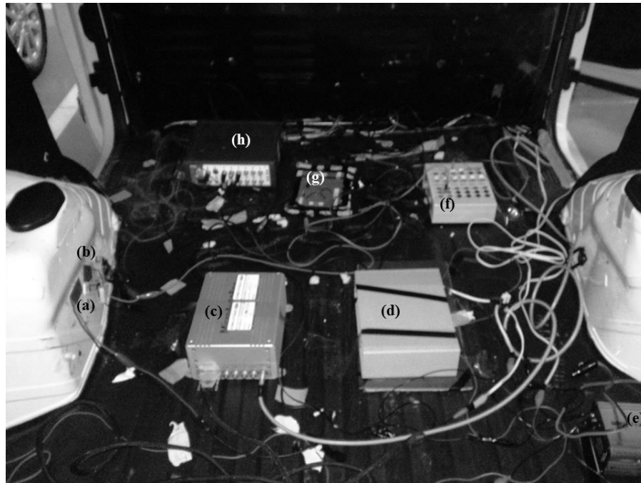
Figure 4.9 Details of the experimental set-up a) PZT actuator b) PZT sensor c) DSpace Autobox d) PZT Amplifier e) DC-DC Inverter f) Autobox Connector g) Signal Conditioner h) Signal Analyzer
