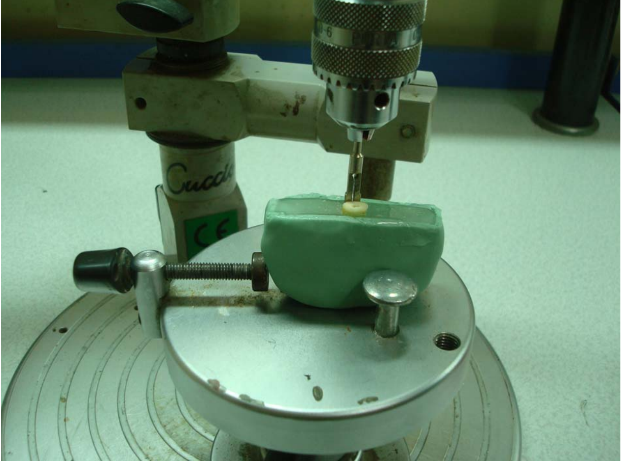
Şekil 3-4: Paralelometrik freze cihazı yardımıyla örneklerin akrilik modele gömülmesi
