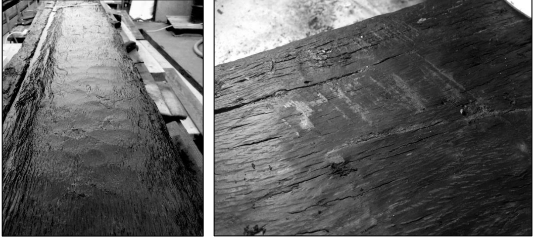
Şekil 40: Omurga üzerindeki balta ya da keser izleri (sol), ve testere izleri (sağ)
