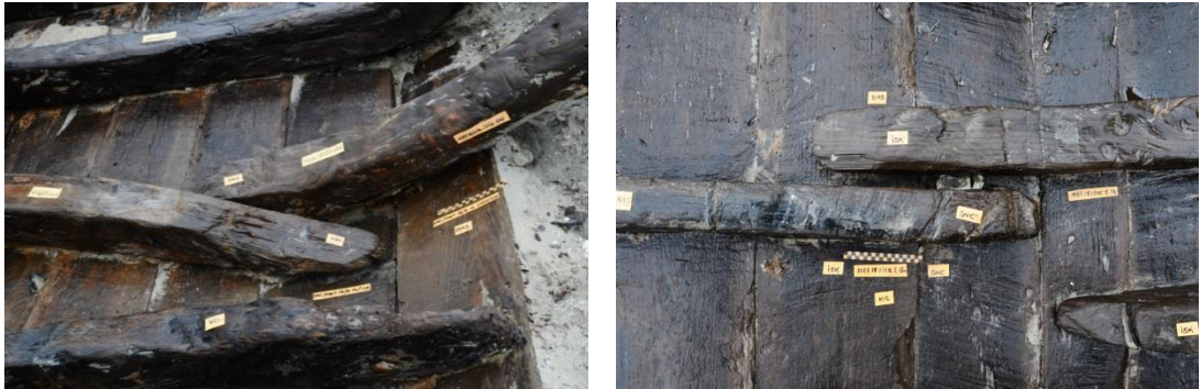
Şekil 55: Eğri ve postaların dizilimi, E16-E16-İK1 (sol), E14-E15 (sağ)
