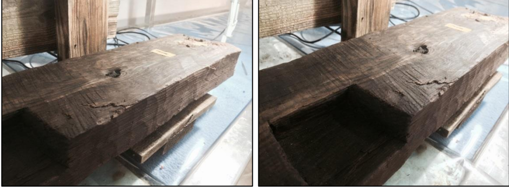
Şekil 69: TP4 yan yüzeydeki balta izleri (sol) ve üst yüzeydeki testere izleri (sağ)
