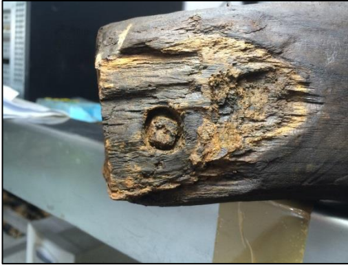
Şekil 59: E10 (sol) ve E22 (sağ) döşeklerindeki matkap delikleri ve demir çivi
