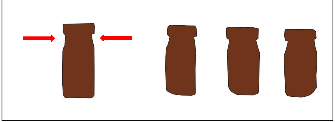
Şekil 37: Omurgadan kesit örnekleri üzerinde aşozların görünümü
