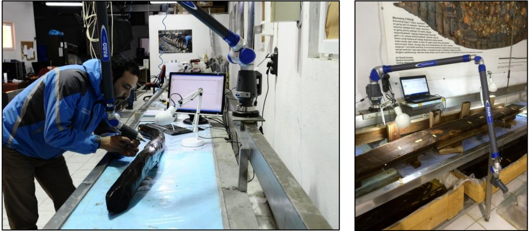
Şekil 23: Digitizer cihazı ve üç boyutlu çizim çalışması
