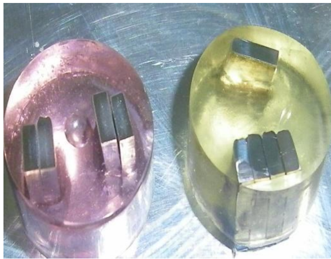
Şekil 6.6. Soğuk kalıplama tekniğiyle bakalite alınan numuneler
