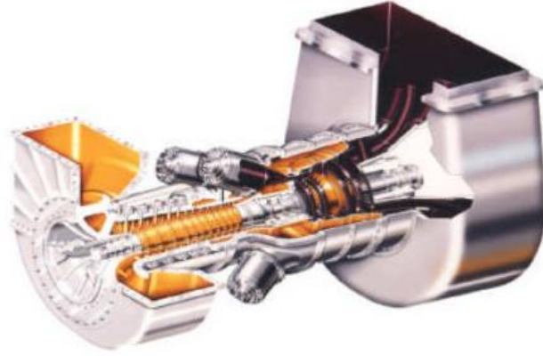
Şekil 2.1. Nikel bazlı süperalaşımdan imal edilen gaz türbin motoru (Loria, 1992).
