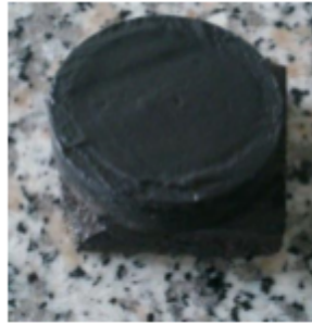
Şekil 3.4. Üzerine pasta borlama ajanı sürülmüş numune (Dinç, 2013).
