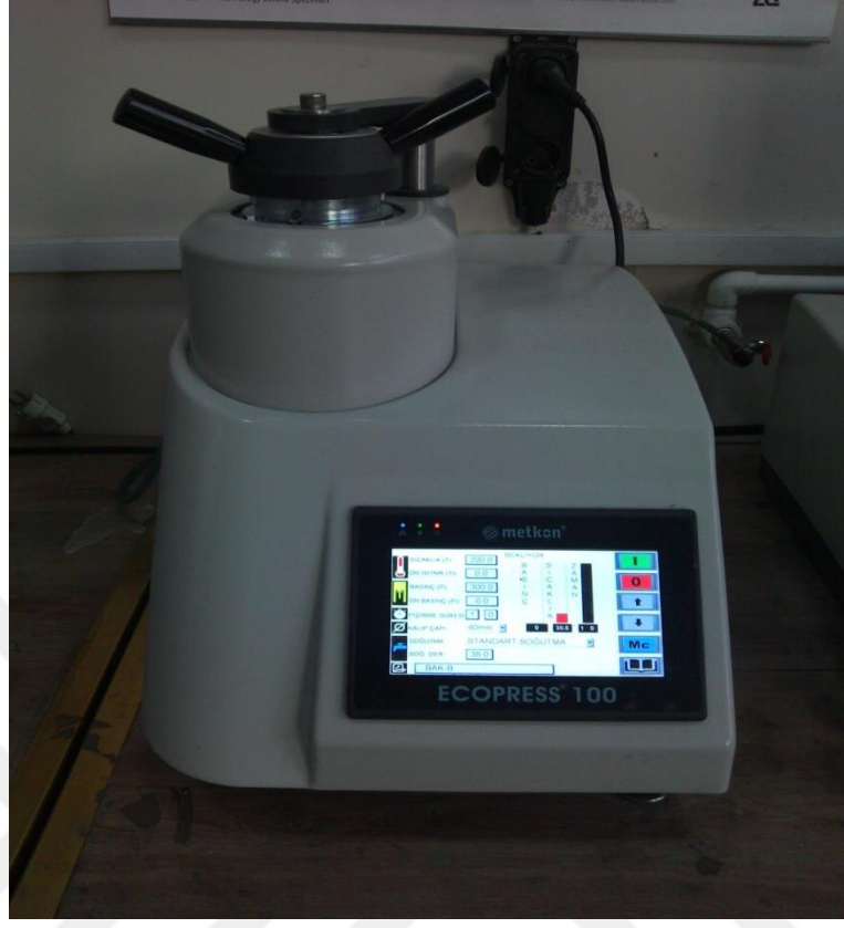
Şekil 6.5. Numune bakalite alma cihazı
