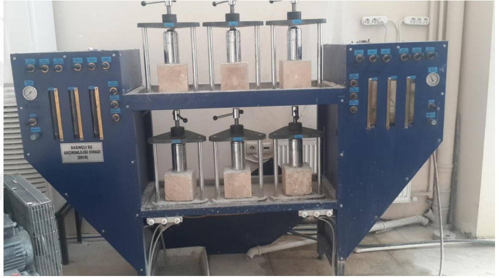
Şekil 3.4. Basınçlı su geçirirliği deney düzeneği
