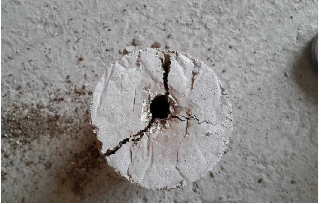
Şekil 4.19. AAECB donatı çekip çıkarıldıktan sonra kırılma şekli
