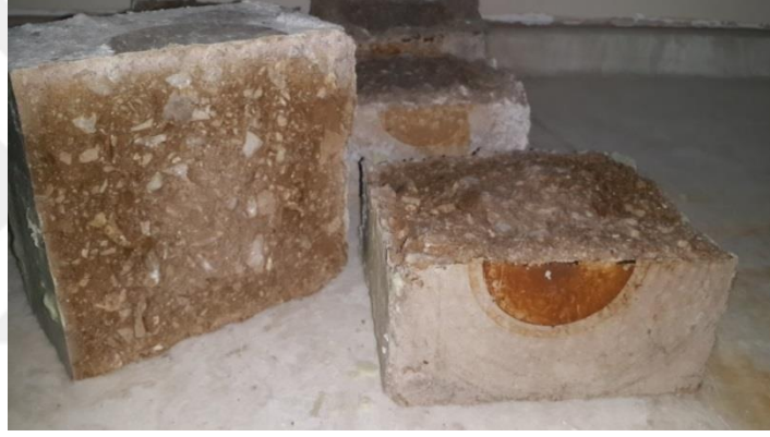
Şekil 4.89. Basınçlı su geçirimsizliği deney sonrasında AAECB numunelerinin su işleme derinliği
