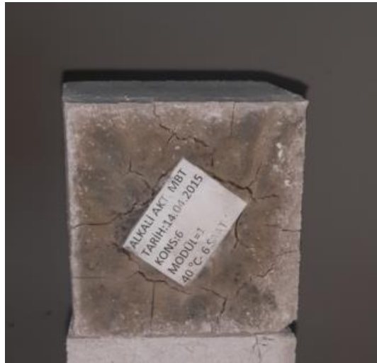
Şekil 4.90. AAECB numunelerin çatlak durumu
