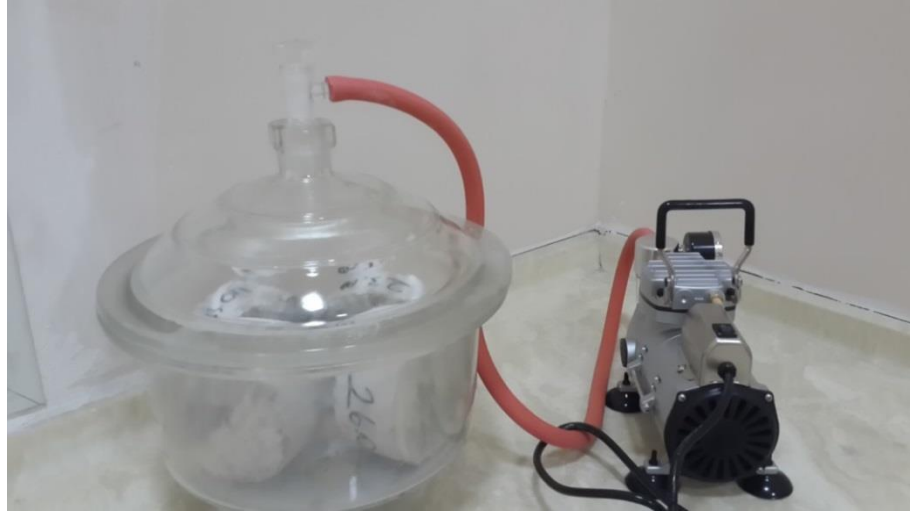
Şekil 3.12. Numunenin desikatörde vakumlanması
