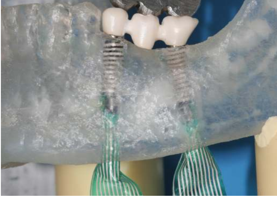
Şekil 3-14: implantların etrafına yerleştirilmiş ve polimerizasyon işlemi tamamlanmış senörlerin görüntüsü
