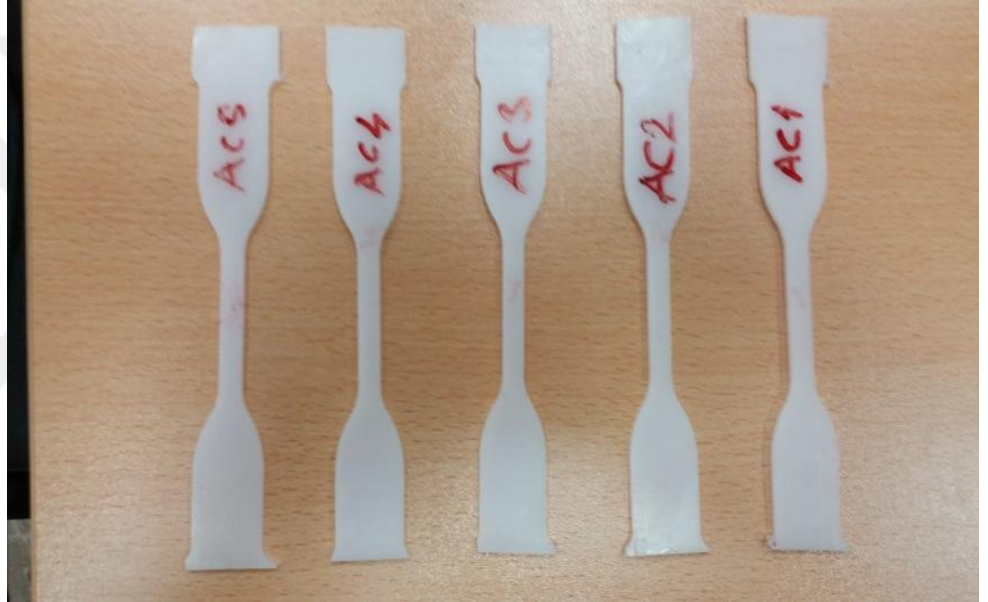
Őekil 24 CNC Cihazında Őekil verilen ekme numuneleri
