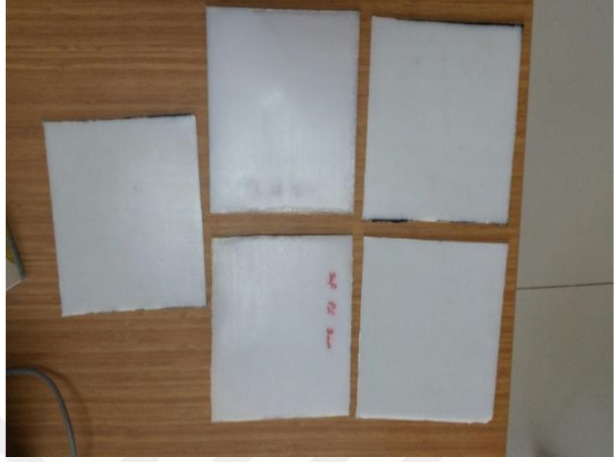
Şekil 19 Sıcak preste levha haline getirilen YYPE
