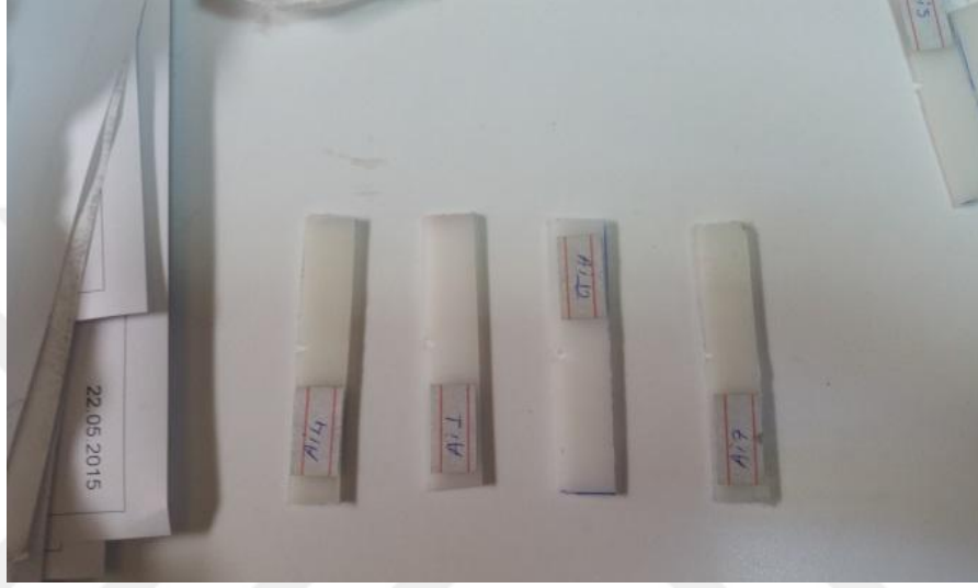
Şekil 29 İzod deneyi numunesi YYPE
