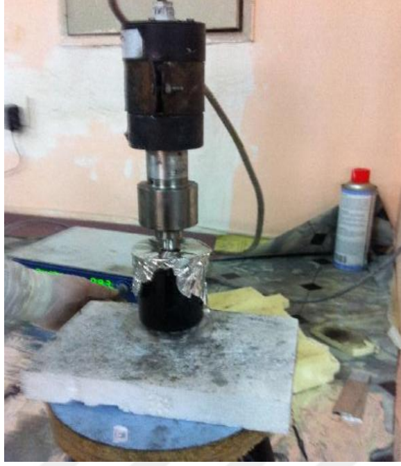
Şekil 12 ÇDKNT'lerin ultrasonic proba karıştırılması
