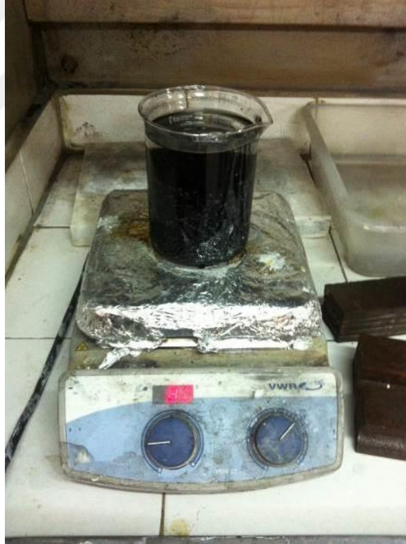
Şekil 13 Isıtmalı manyetik karıştırma işlemi
