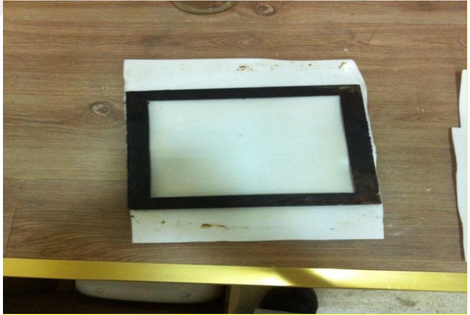
Şekil 22 Beyaz teflon ayırıcı yüzey ve çerçeve kalıp
