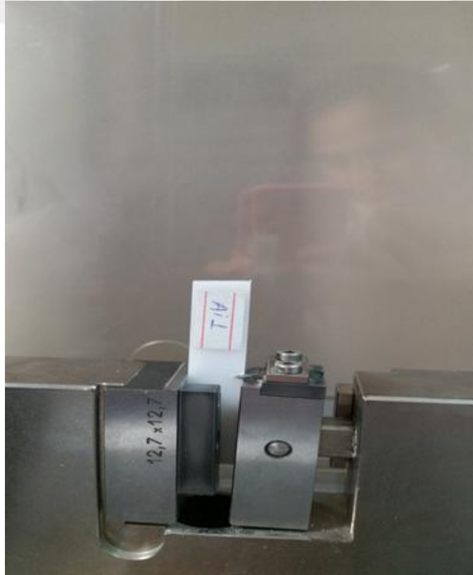
Şekil 32 Numunenin izod deneyi cihazına yerleştirilmesi
