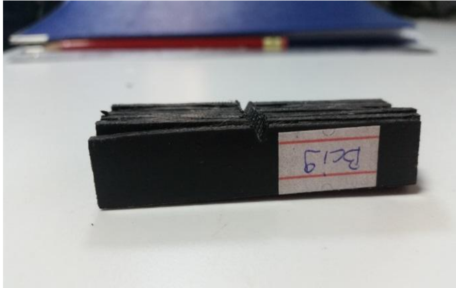
Şekil 30 İzod deneyi numunesi % 1 KNT/cam elyaf/YYPE
