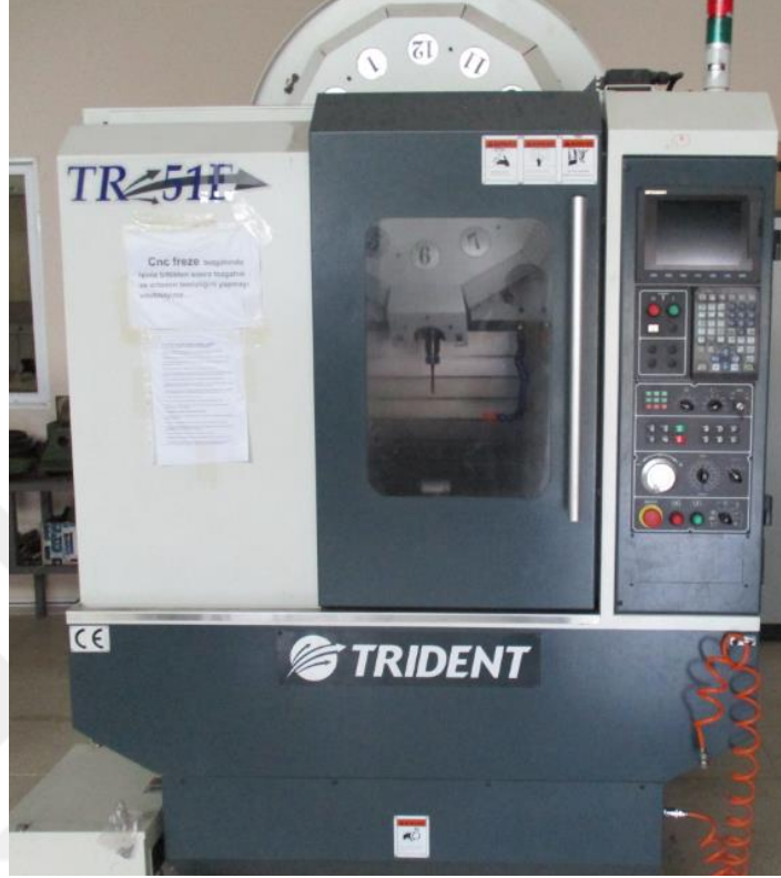
Şekil 3.3. Kaynak işleminde kullanılan CNC freze tezgahı
