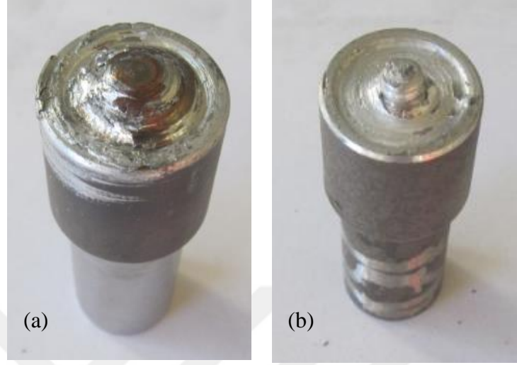
Şekil 4.5. SKK sonrasında karıştırıcı uç durumu (a) sıfır takım komunu (b) 0.75,1.5 mm takım konumlandırması
