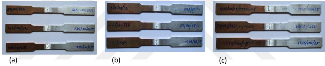
Şekil 4.11. 1525 dev/dak takım dönme hızında çekme testi sonrası yüzey görüntüleri, (a) 1525/100/0.75 numunesi, (b) 1525/75/1.5 numunesi, (c) 1525/100/1.5 numunesi
