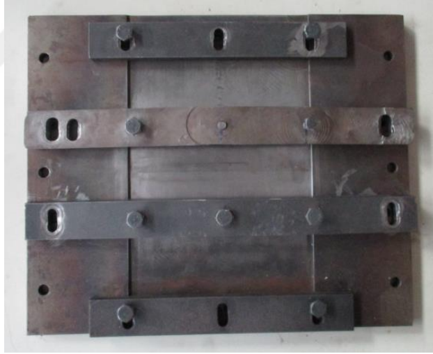
Şekil 3.2. Al ve Cu levhaların SKK yöntemiyle birleştirilmesinde kullanılan sabitleme kalıbı
