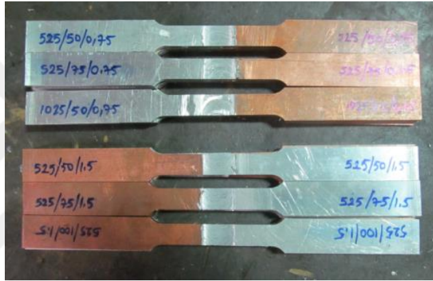
Şekil 3.7. SKK yöntemiyle birleştirilen Al ve Cu levhalardan talaşlı imalat yöntemiyle elde edilen çekme numuneleri
