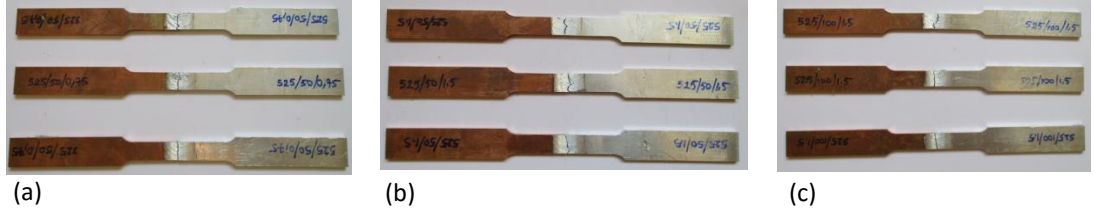
Şekil 4.9. 525 dev/dak takım dönme hızında çekme testi sonrası yüzey görüntüleri, (a) 525/50/0.75 numunesi, (b) 525/50/1.5 numunesi, (c) 525/100/1.5 numunesi
