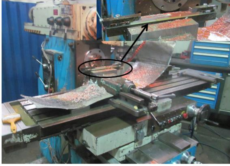
Şekil 3.9. EN 10002-1standardına göre çekme numunelerin freze tezgahında hazırlanması
