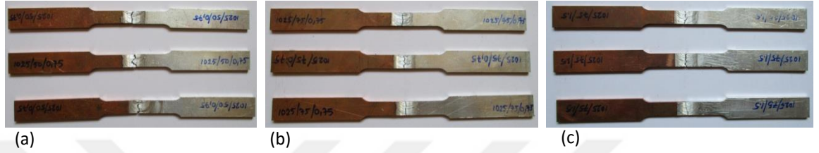
Şekil 4.10. 1025 dev/dak takım dönme hızında çekme testi sonrası yüzey görüntüleri, (a) 1025/50/0.75 numunesi, (b) 1025/75/0.75 numunesi, (c) 1025/75/1.5 numunesi
