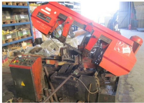
Şekil 3.8. Kaynaklı levhaların hidrolik şerit testere ile kesilmesi
