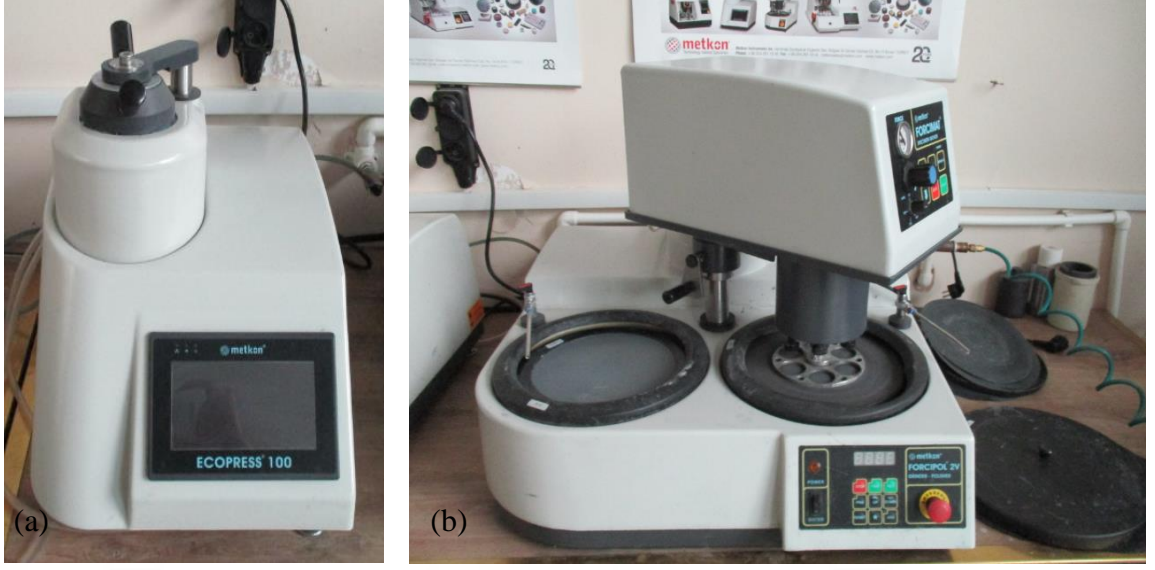
Şekil 3.14. Metalografik inceleme için kullanılan cihazlar a) Bakalite alma cihazı b) Zımparalama ve parlatma cihazı
