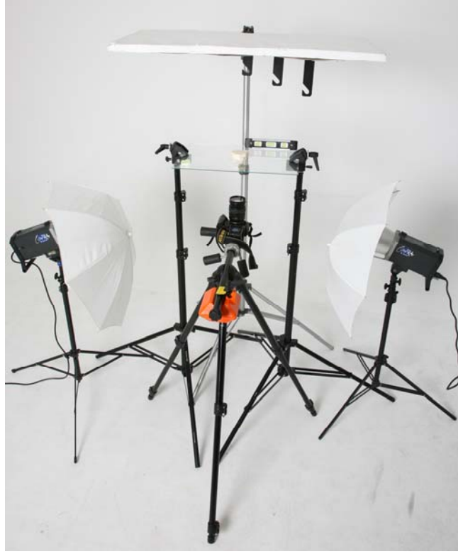
Şekil 3-7: Ortodontik modellerin oklüzal yüzey görüntülerinin elde edilmesi sırasında kullanılan düzenek
