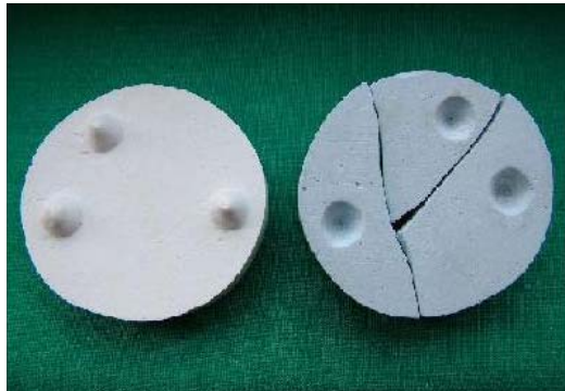
Şekil 3-3: Anahtar kilit sisteminin oluşturulması
