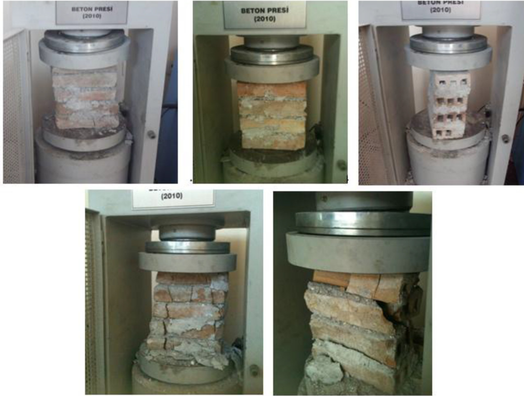
Şekil 3.4. Eksenel basınç altında test edilmek üzere hazırlanan duvar elemanları ve basınç kuvveti altında duvar elemanlarının test edilmesi
