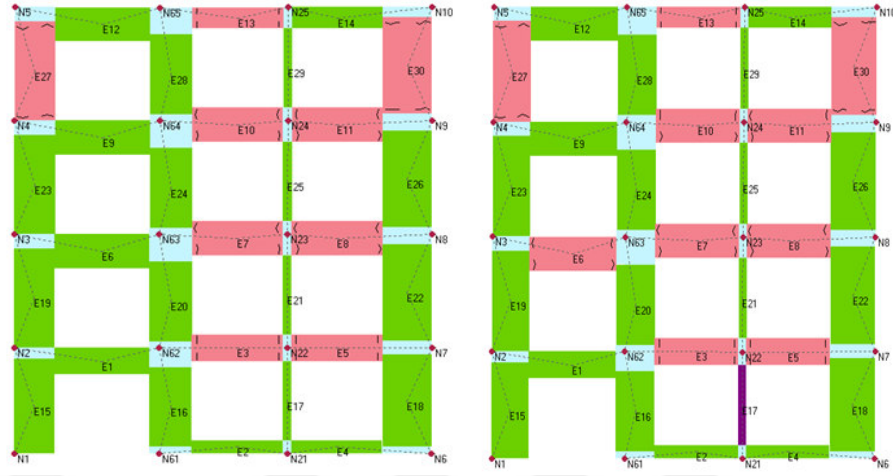
Şekil 4.23. Mıntıka 2 P 811 binası 1 no'lu duvarın +Y yönü performans ve göçme noktasında hasar seviyeleri ve kırılma türleri
