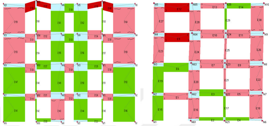
Şekil 4.17. Mıntıka 2 P 811 binası 1 no'lu duvarın +X yönü performans ve göçme noktasındaki hasar seviyeleri ve kırılma türleri
