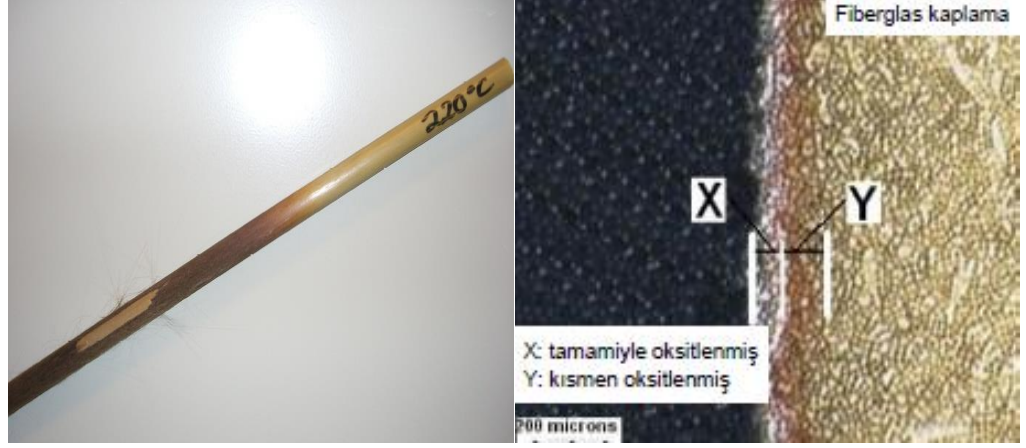
Şekil 2.11. Kompozit öz numunesinin bir yıl boyunca 220°C’de fırınladığı, Oksidasyon ~60 mikron derinliği geçmediği görülmüştür (CTC Global, 2011)
