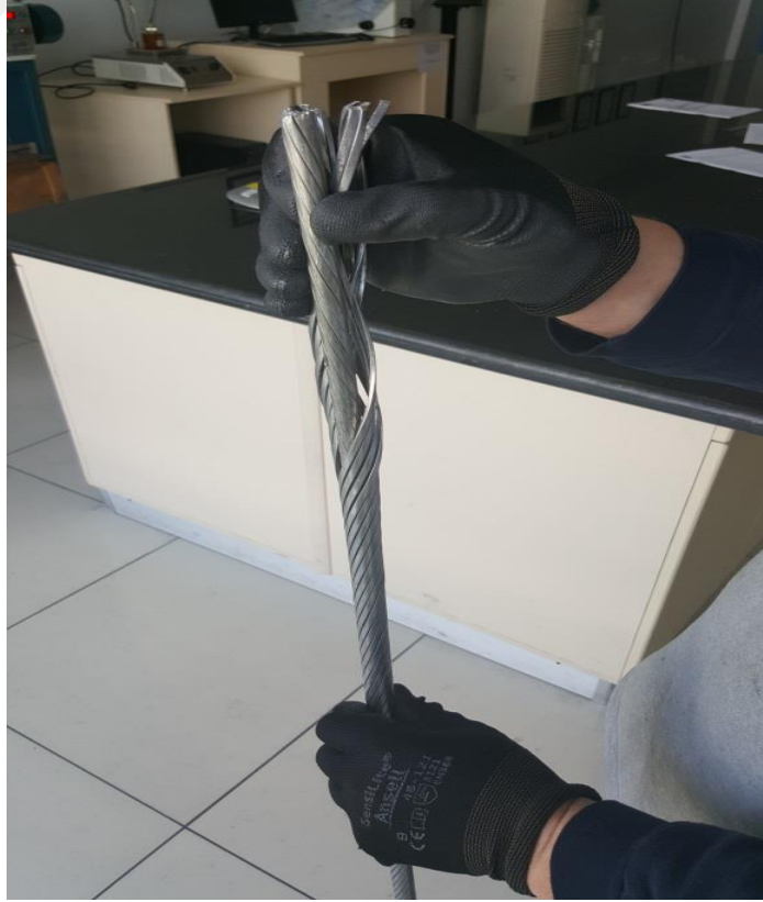
Şekil 4.16. 12 telli üst katmanın soyulması
