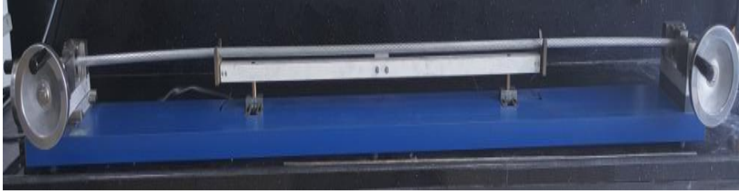
Şekil 4.30. ACCC Silvassa iletkenin direnç ölçer cihazına yerleřtirilmesi
