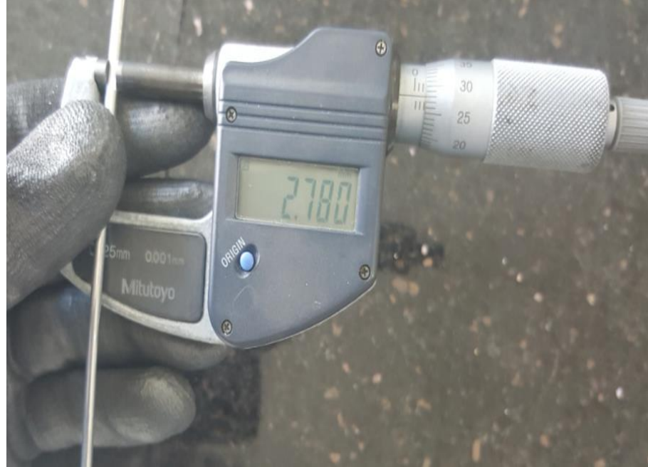
Şekil 4.24. Yuvarlak şekilli tellerin çapının ölçülmesi
