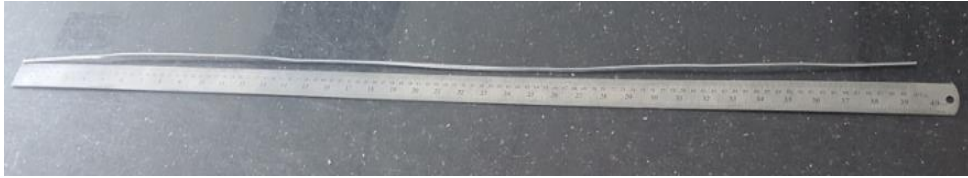
Şekil 4.27. ACCC Silvassa iletkeni trapez şeklindeki telin 1 metre uzunlukta kesilmesi
