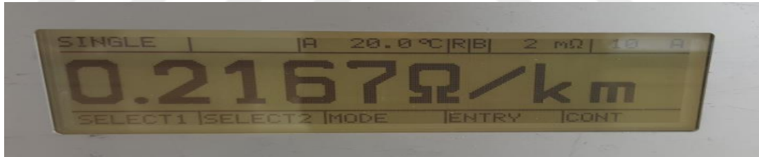
Şekil 4.31. ACCC Silvassa iletkenin ölçülen direnç deđeri
