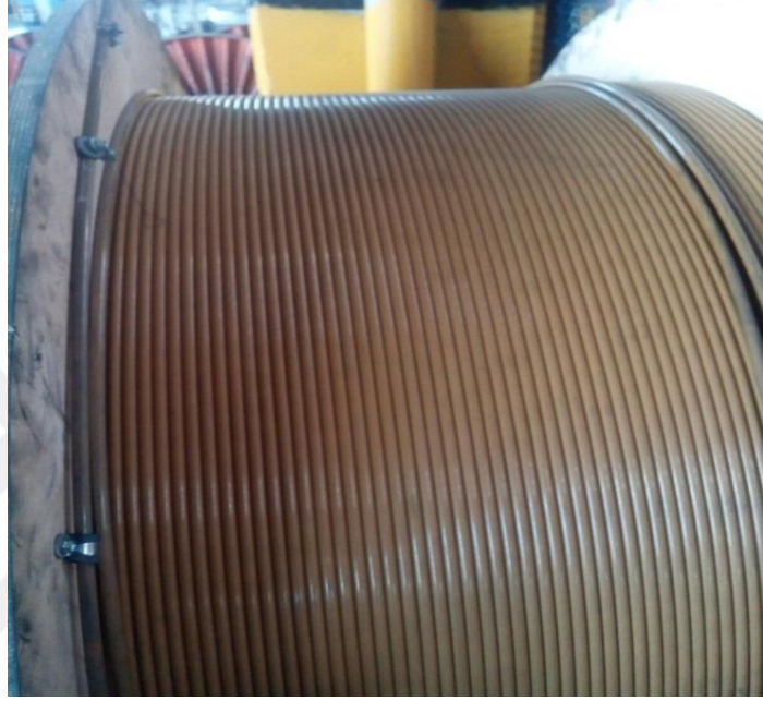
Şekil 3.5.Kompozit özün makaraya sarılmış hali
