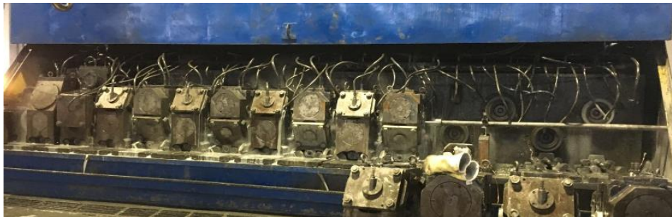
Şekil 3.8. Döküm prosesi haddeleme ünitesi
