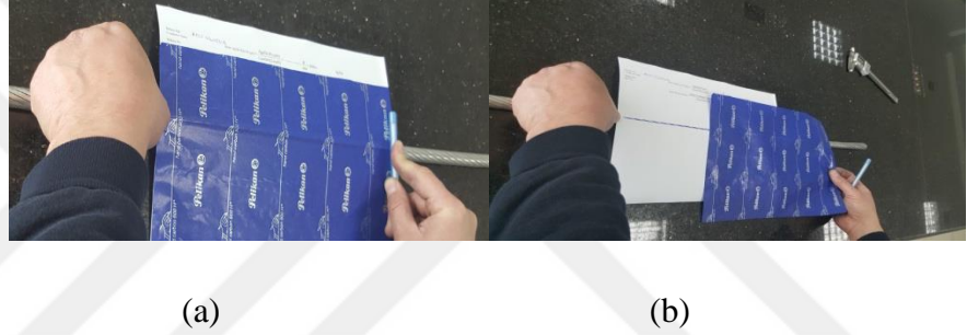
Şekil 4.12. Üst katmanda bulunan iletken tellerin izlerinin karbon kağıdı yardımıyla kağıda çıkarılması
