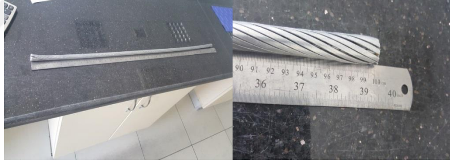
Şekil 4.21. ACCC Silvassa iletkeninin 1 metre (1000mm) ölçülen iletken uzunluğunun gösterilmesi
