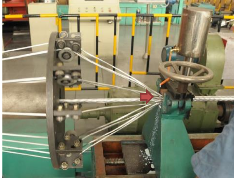
Şekil 3.17. Örme makinesinde tellerin haddeye girmeden emülsiyon yağı kullanılması
