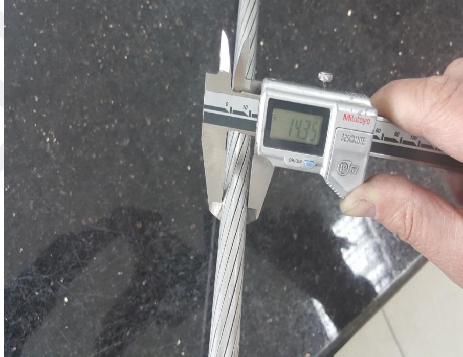
Şekil 4.14. Kumpas yardımıyla en üst katman 12 telli tabakanın iletken çapının ölçülmesi sonucu üst katmanın çapının 14.35 mm olduğu görülmüştür
