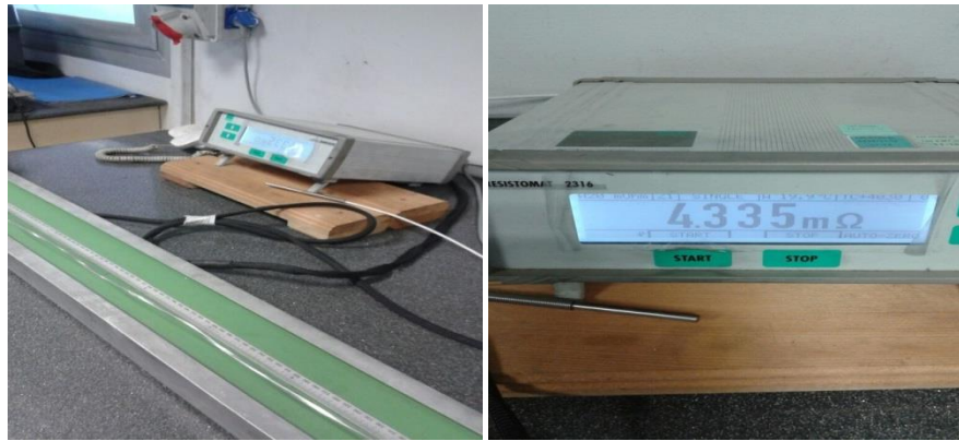
Şekil 4.29. ACCC Silvassa iletkeninde kullanılan 1 metre uzunluğunda tek telin direnci 4,333 m \Omega olarak ölçülmüştür
