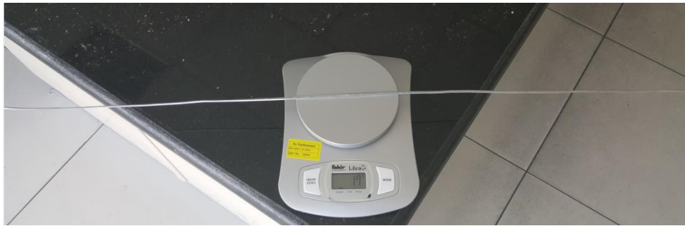
Şekil 4.28. 1 metre uzunluğundaki telin hassas teraziyle tartılması sonucu 17 gr geldiği görülmüştür
