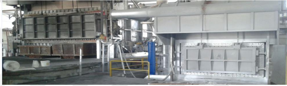
Şekil 3.6. Döküm prosesi ergime ve dinlendirme fırınları
