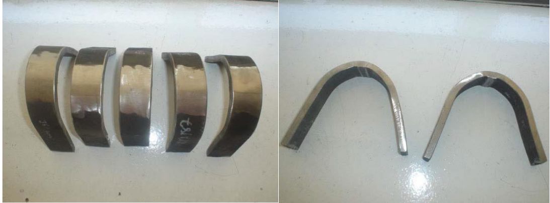
Şekil 5.2. Eğme deneyi sonucunda numunelerin iki farklı açıdan görünüşü
