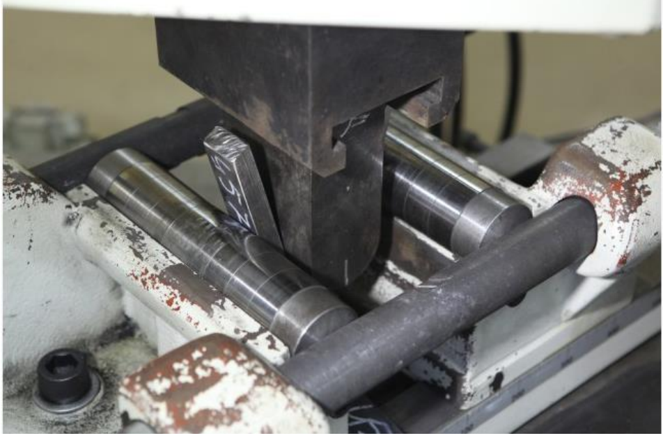
Şekil 3.38. Eğme testi uygulaması
