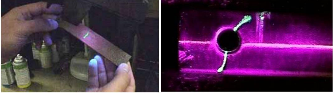
Şekil 3.47. Flüoresan penetrant (girici) sıvıyla ultraviyole ışınları altında yapılan test resimleri
