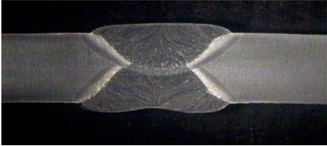
Şekil 4.1. Kaynağın makro görüntüsü (X42, 4.76 mm)
