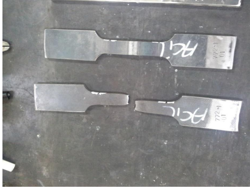
Şekil 3.32. Çekme testi uygulaması
