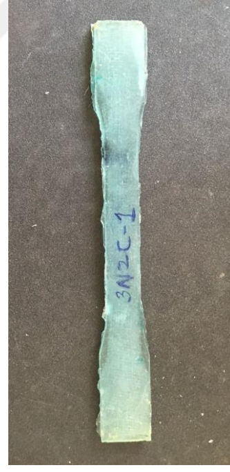
3NF/2CK tabakalı numune
