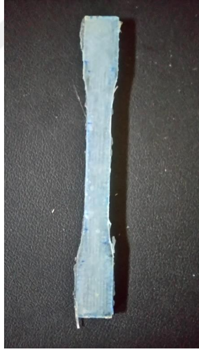
1NF/2CK tabakalı numune
