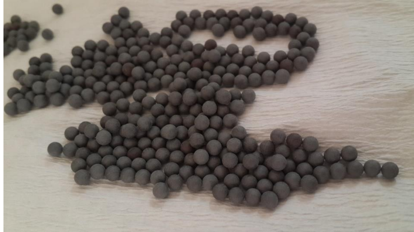
Şekil 3.5. Çapı 3.8mm olan bilyalar
