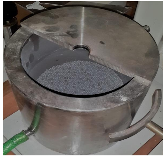
Şekil 4.3. Öğütme işleminde kullanılan bilyalar
