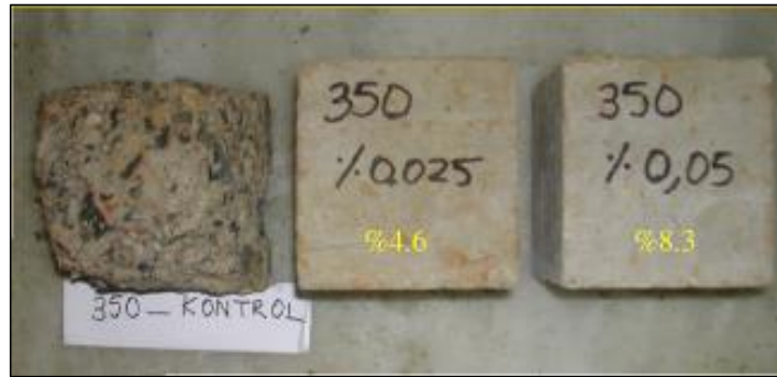
Şekil 3.33. Donma-çözünme devrine maruz kalmış, 100x100x100 mm boyutlarında küp beton numuneleri
