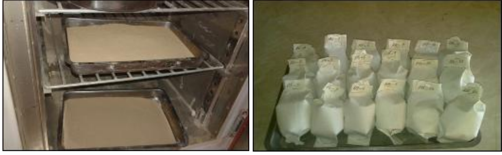
Şekil 3.32. Kil malzemesinin etüv sonrası görünümü ve Filtre kâğıdında sınıflandırılmış karışımı
