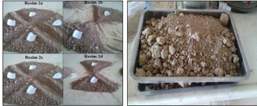
Şekil 3.28. Kareleme dörtleme ve numune azaltma
