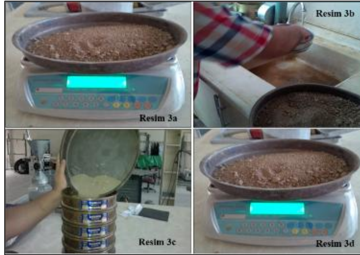
Şekil 3.26. Islak elek analizi yöntemi
