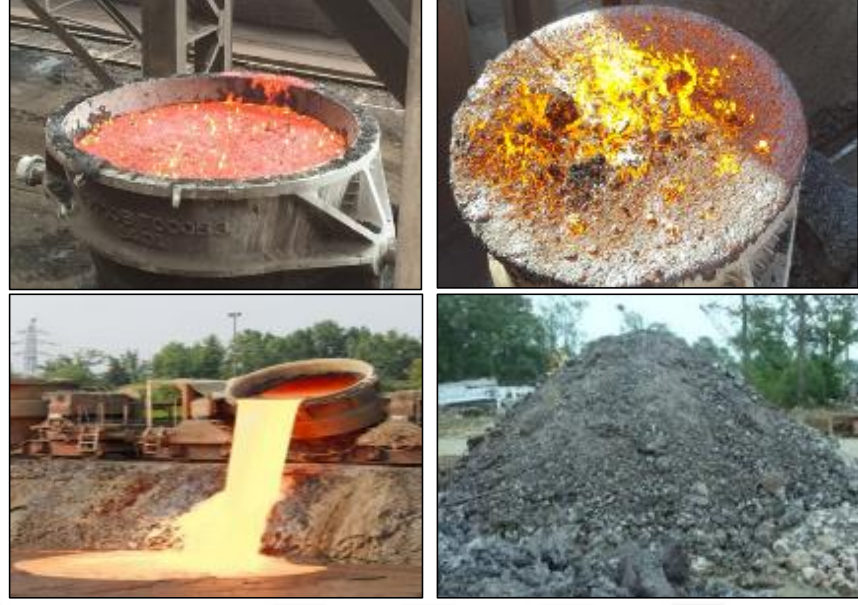
Şekil 3.7. Pota içindeki çelikhane curufu [16].
