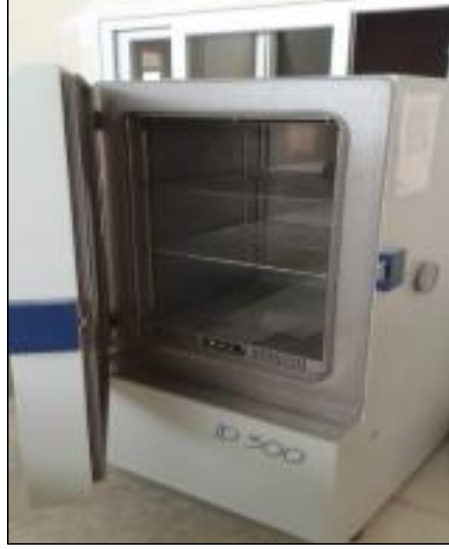
Şekil 3.21.ID 300 Klimatik test kabini [11].
