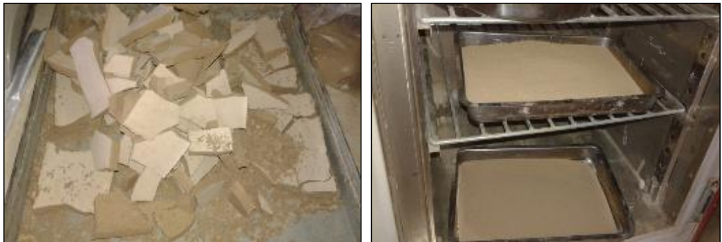
Şekil 3.27. Yaş kil numunesinin etüv sonrası ve öğütülerek (0.075 mm) kuru elek altı malzemesi (İSTE Geoteknik Lab.)
