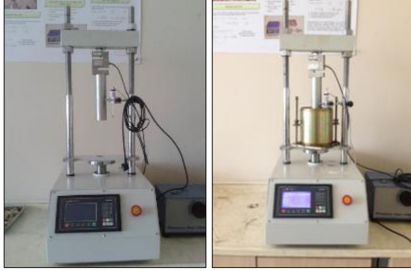
Şekil 3.38. CBR deney aleti (İSTE Geoteknik laboratuvarı).
