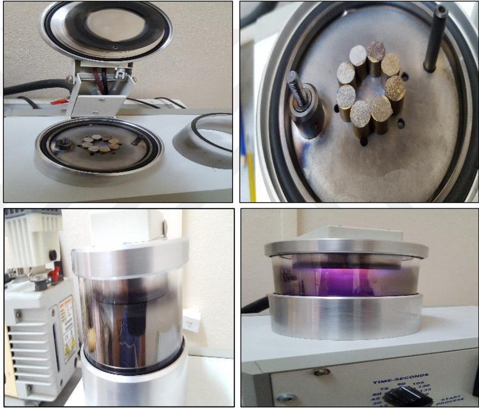
Şekil 5.1. Numunelerin Au-Pd tabakası ile kaplanması
