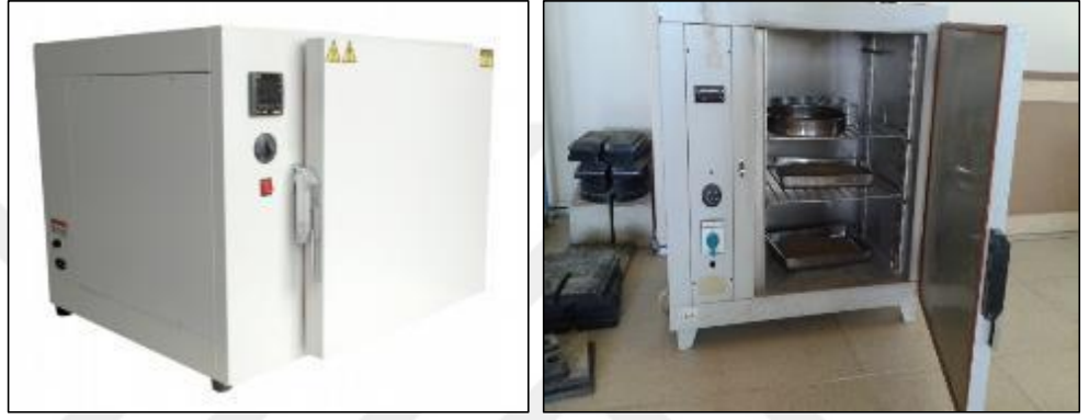
Şekil 3.22. Etüv cihazı (İSTE Geoteknik laboratuvarı)
