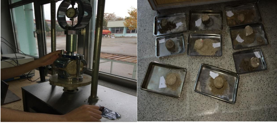
Şekil 6.1.a. Marshall Stabilizasyon Deneyi Şekil 6.1.b. Deney Sonrası Numuneler
