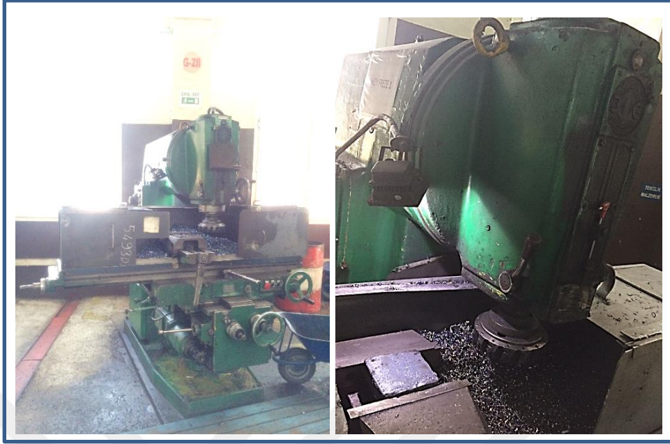
Şekil 3.16. Freze işleme makinesi
