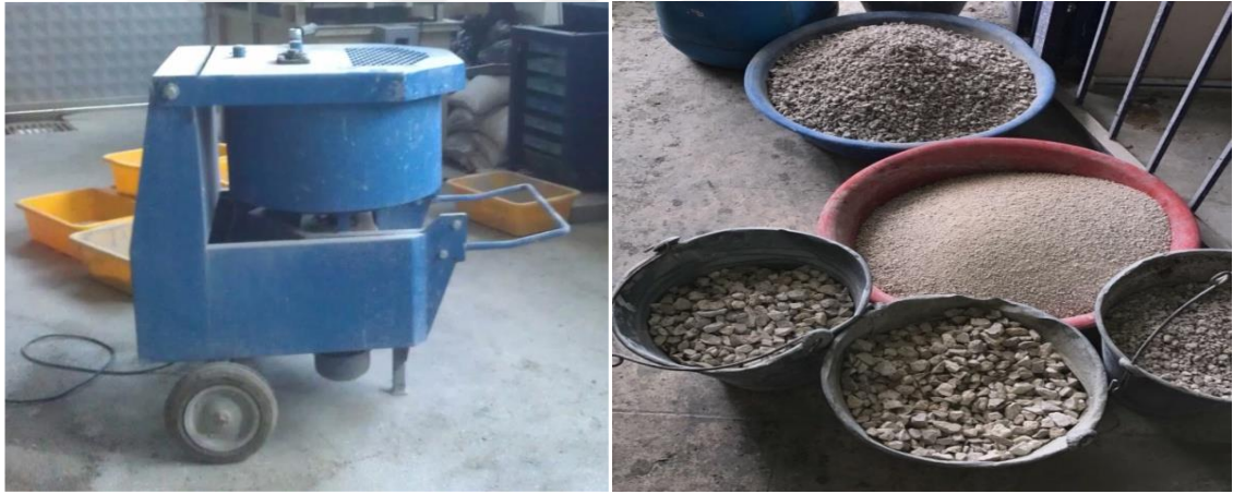
Şekil 3.1. 56 litre kapasiteli betonyer ve bazı deney karışım malzemeleri
