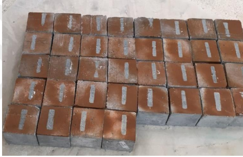
Şekli 3.7. Aşınma direnç deneyine tabi tutulan beton numuneler
