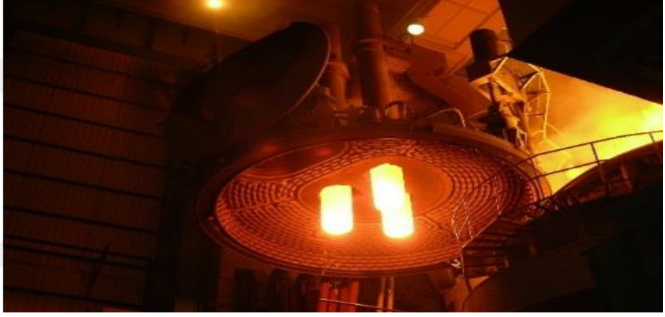
Şekil 1.4. EAF içerisindeki grafit elektrotları (European Commission, 2001)
