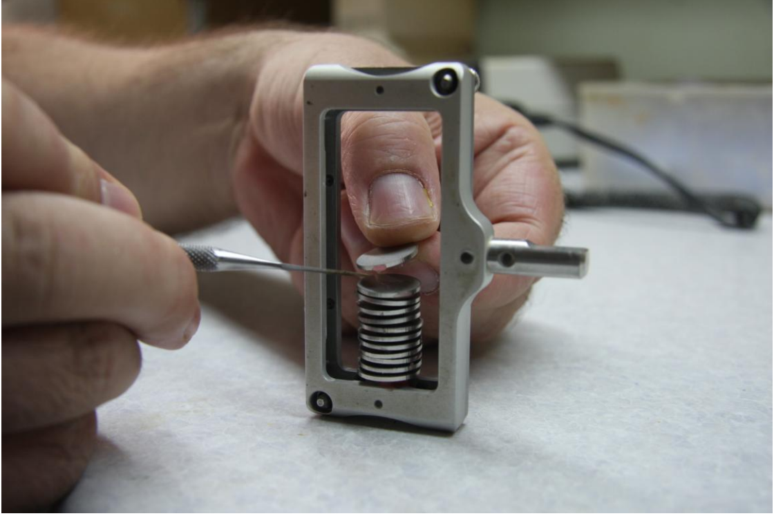
Şekil 3-10: Metal disklerin Cercon çerçevelerine yerleştirilmesi
