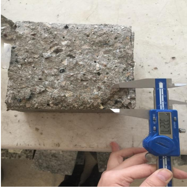
Resim 4.11. Basınçlı su geçirimsizliği deneyi sırasında su işleme derinliğinin ölçülmesi
