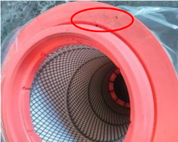
Resim 4.3. Kullanım ömrünü tamamlamış kalıp ile üretilen mamul
