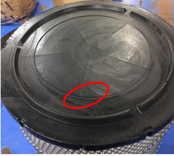
Resim 4.5. Kalıp izi ve lekelenme oluşan mamül
