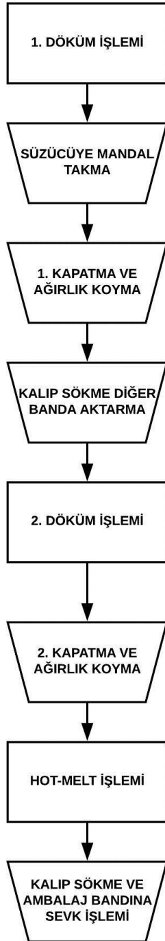
Şekil 3.2. Mevcut montaj hattı proses akış şeması
