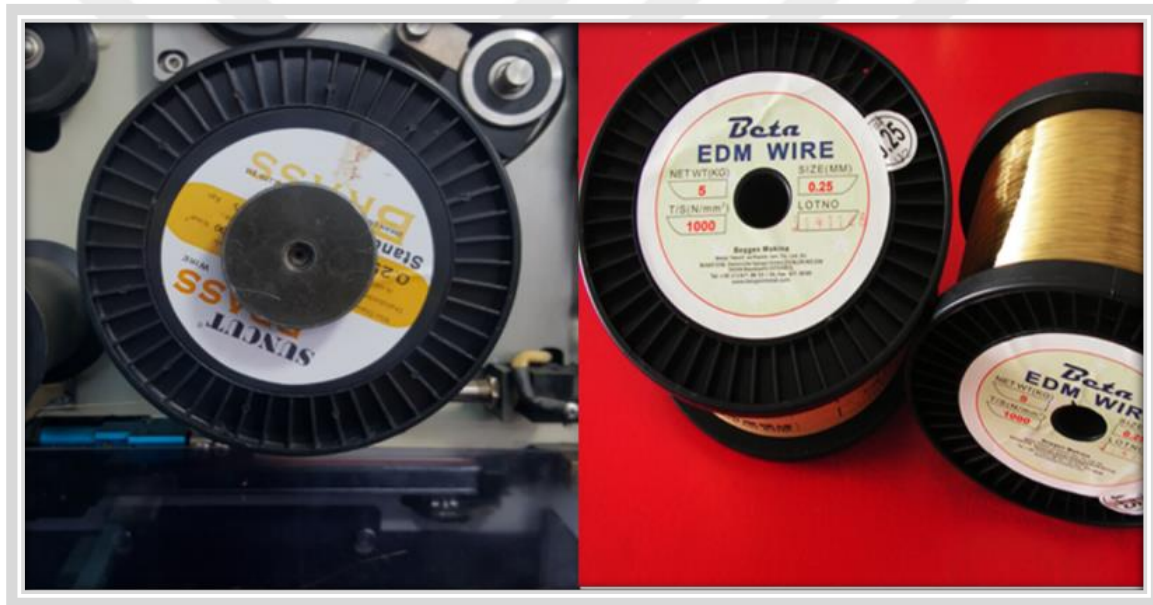
Resim 3.2. Çalışmada kullanılan pirinç tel elektrotlar
