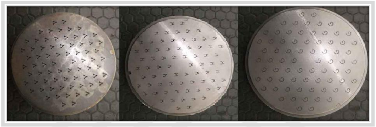
Resim 1.2. Farklı kesitler açılmış Düze Kalıpları
