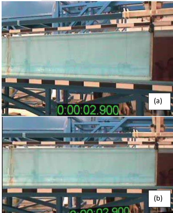
Şekil 3.7. Perpektif kalibrasyon a) ham görüntü b) kalibrasyonlu görüntü (Kocaman, 2007)
